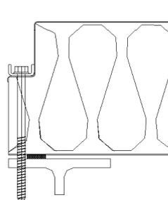
Lastverteilplatte der Stahlgüte S 235: t = 2 mm
