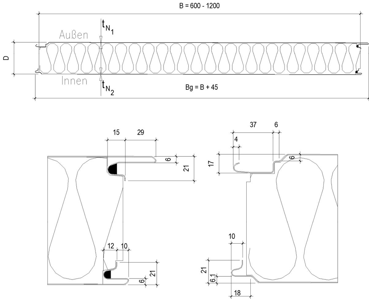
Profil außen: Typ S, G, V, V2, V6, M, M2, M3, X
