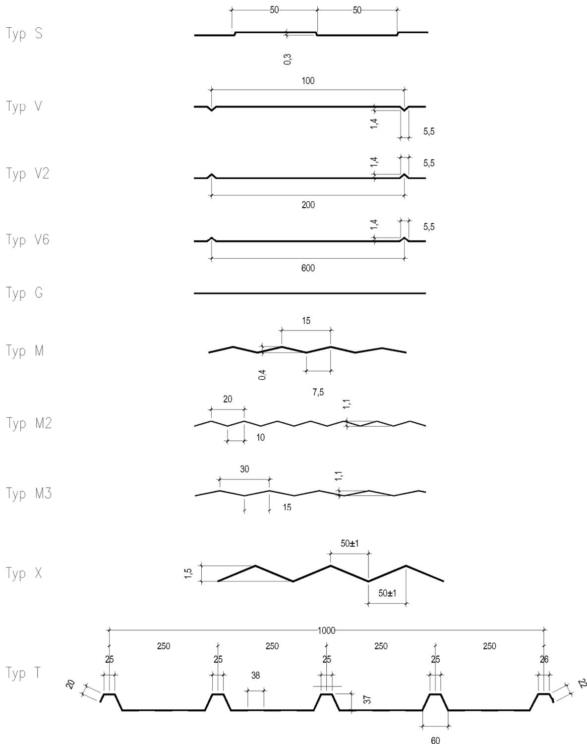
Sandwichelemente "Trimoterm A12T1" nach EN 14509 mit Stahldeckschichten und einer Kernschicht aus Mineralwolle
