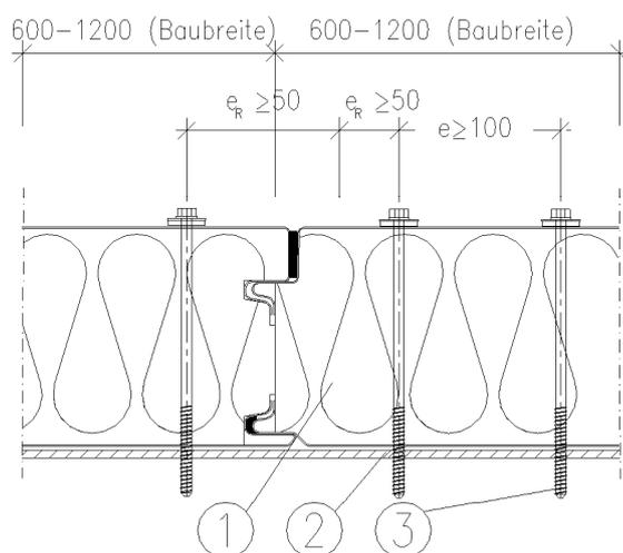
Parallel zur Spannrichtung:  $e_r = 50 \text{ mm}$
