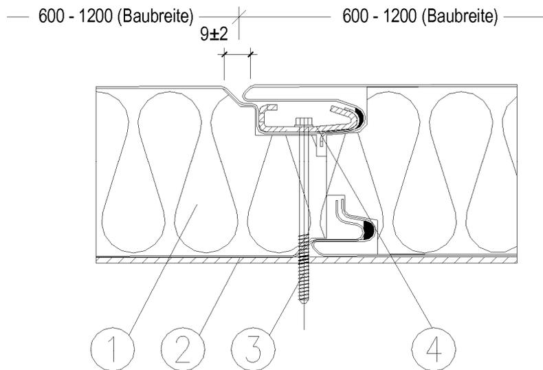
Parallel zur Spannrichtung: e<sub>R</sub> ≥ 400 mm
