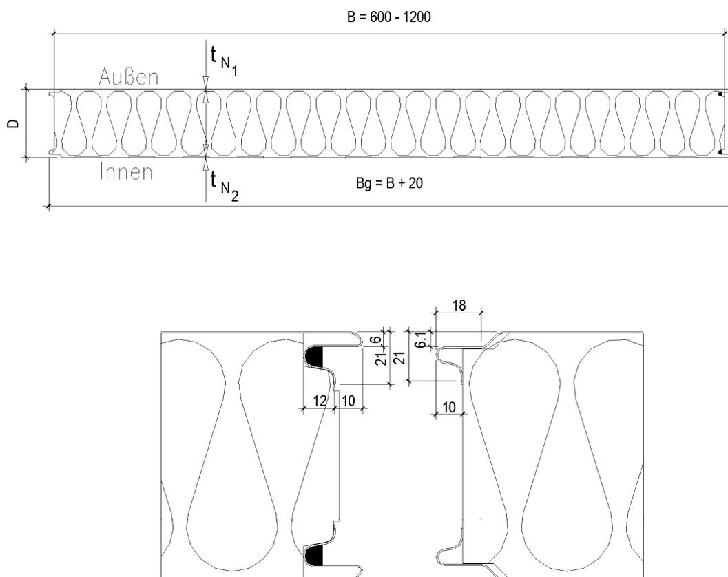
Profil außen: Typ S, G, V, V2, V6, M, M2, M3, X
