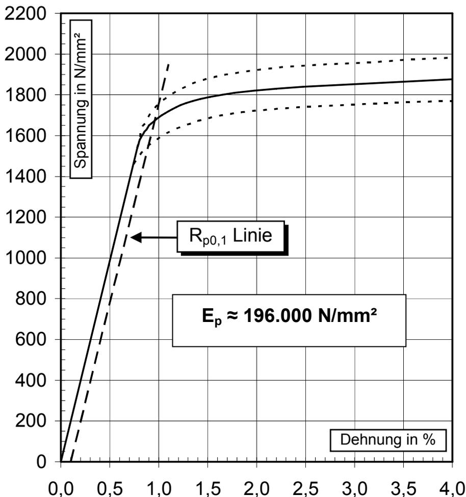
Die gestrichelten Linien markieren den Bereich, innerhalb dessen die tatsächlichen Spannungs - Dehnungslinien auftreten können.
