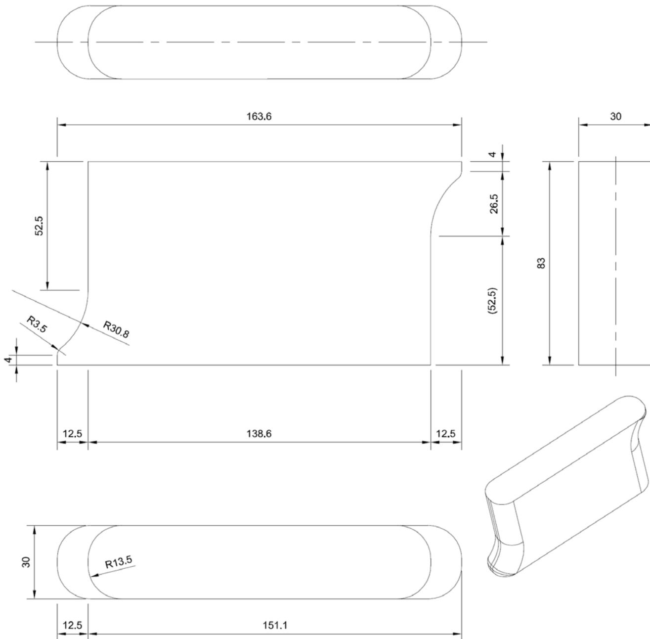
Bild 15: Abmessungen Druckschublager HIT-SP
