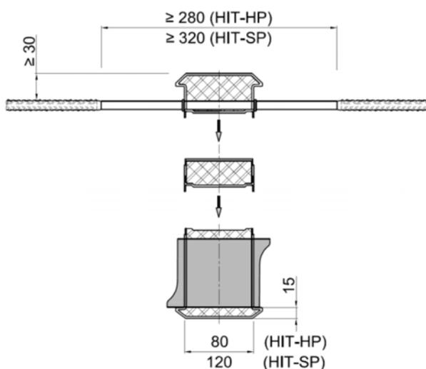
Bild 12: Halfen-Iso-Element HIT-HP/SP MV F 120-AB/REI 120
