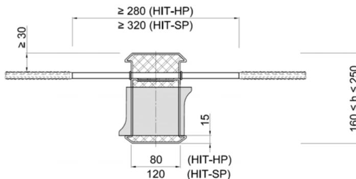
Bild 10: Halfen-Iso-Element HIT-HP/SP MV F 120-AB/REI 120
