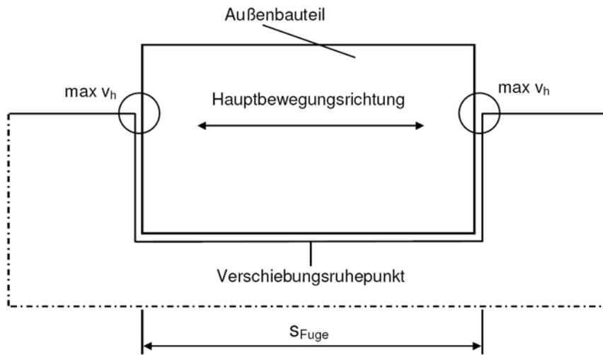
Bild 22: Einbausituation mit Lagerung an gegenüberliegenden Platten
