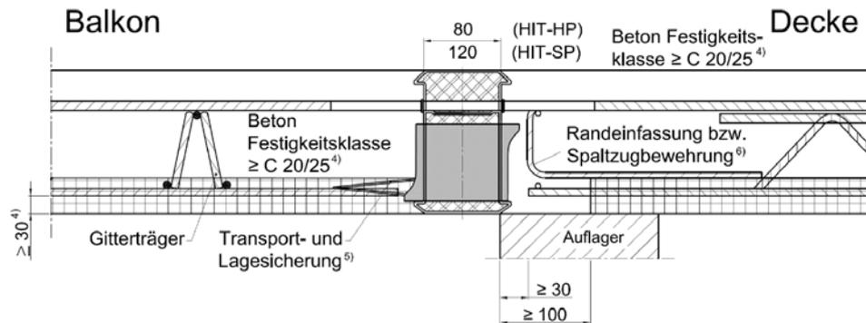
Bild 26: Beispiel für den Anschluss HIT-HP/SP MV F 120-AB/REI 120 an Elementplatten mit statisch - wirksamer Ortbetonschicht
