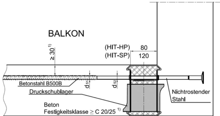
Bild 8: Halfen-Iso-Element **HIT-HP/SP MV-...-WD** F 120-AB /REI 120 im eingebauten Zustand
