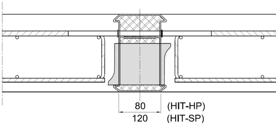
Bild 4: Halfen-Iso-Element **HIT-HP/SP MV F 120-AB / REI 120** im eingebauten Zustand
