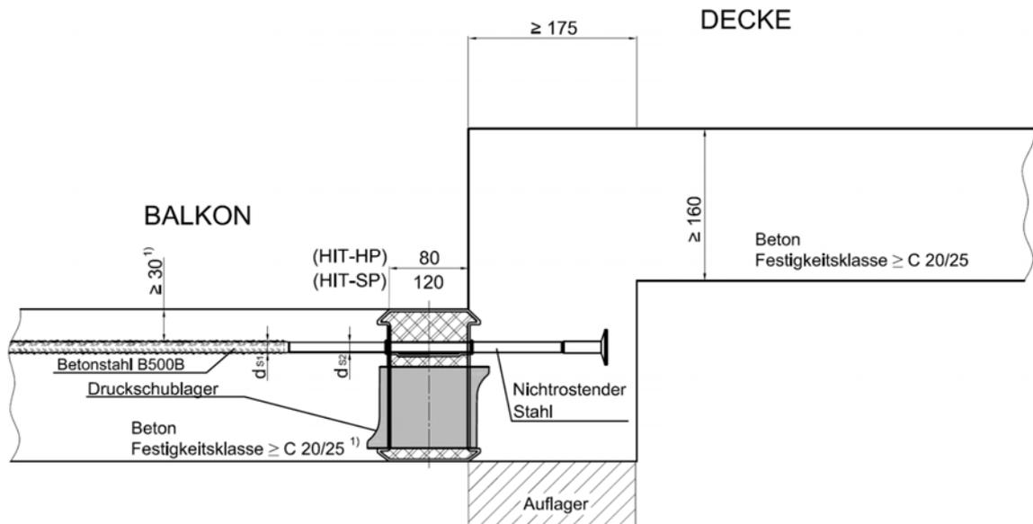
Bild 6: Halfen-Iso-Element **HIT-HP/SP MV-...-OD** F 120-AB /REI 120 im eingebauten Zustand
