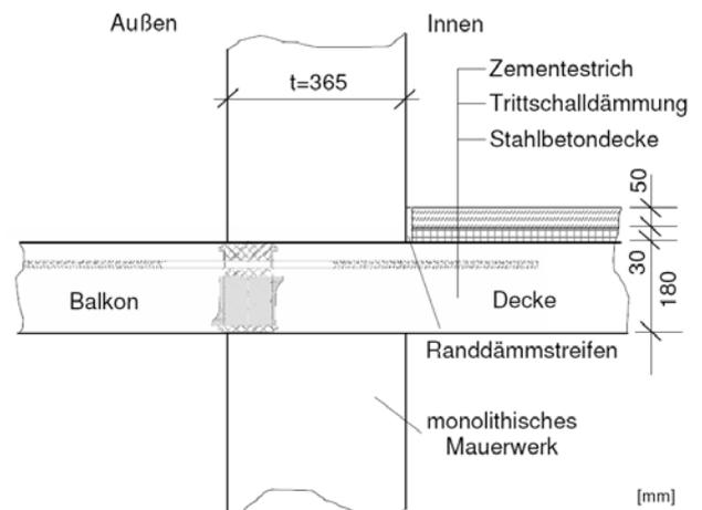
Bild 32: Einbausituation Mauerwerk mit WDVS und monolithisches Mauerwerk
