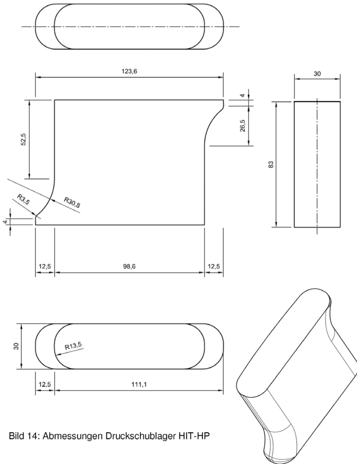
Bild 14: Abmessungen Druckschublager HIT-HP
