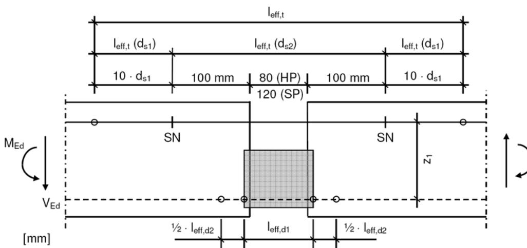
Bild 25:  $l_{\text{eff}}$  für nichtrostenden Rundstahl S 460 und S 690 nach Datenblatt
