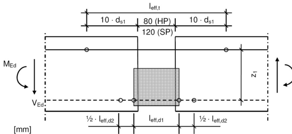
Bild 24:  $l_{\text{eff}}$  für Betonstahl B500 NR
