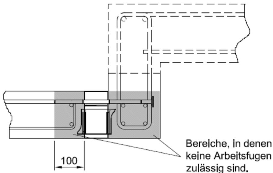
Bild 21b: Bewehrungsführung für HIT HP/SP MV -OD, -WD, Bewehrung der sich anschließenden Deckenplatte bzw. Wand nach DIN 1045-1 bzw. DIN EN 1992-1-1, Lage der Arbeitsfugen
