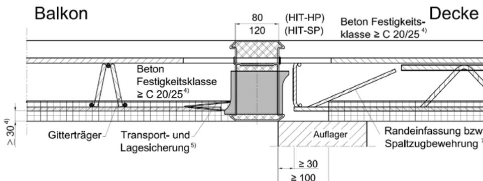
Bild 27: Beispiel für den Anschluss HIT-HP/SP MV F 120-AB/REI 120 an Elementplatten mit statisch - wirksamer Ortbetonschicht
