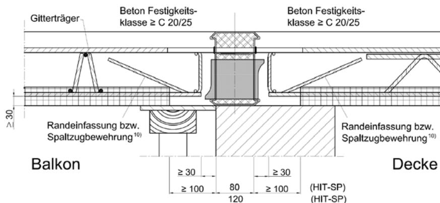
Bild 30: Beispiel für den Anschluss HIT-HP/SP MV F 120-AB/REI 120 an Elementplatten mit statisch - wirksamer Ortbetonschicht
