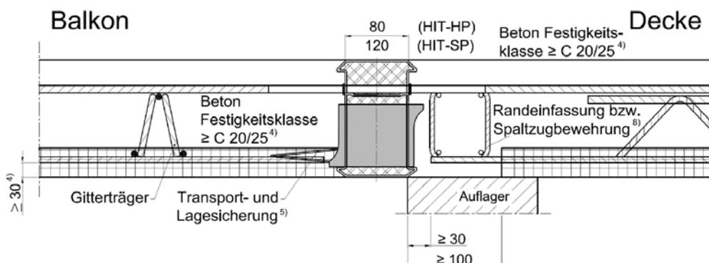
Bild 28: Beispiel für den Anschluss HIT-HP/SP MV F 120-AB/REI 120 an Elementplatten mit statisch - wirksamer Ortbetonschicht
