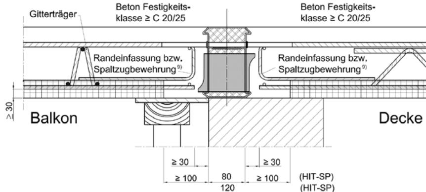
Bild 29: Beispiel für den Anschluss HIT-HP/SP MV F 120-AB/REI 120 an Elementplatten mit statisch - wirksamer Ortbetonschicht
