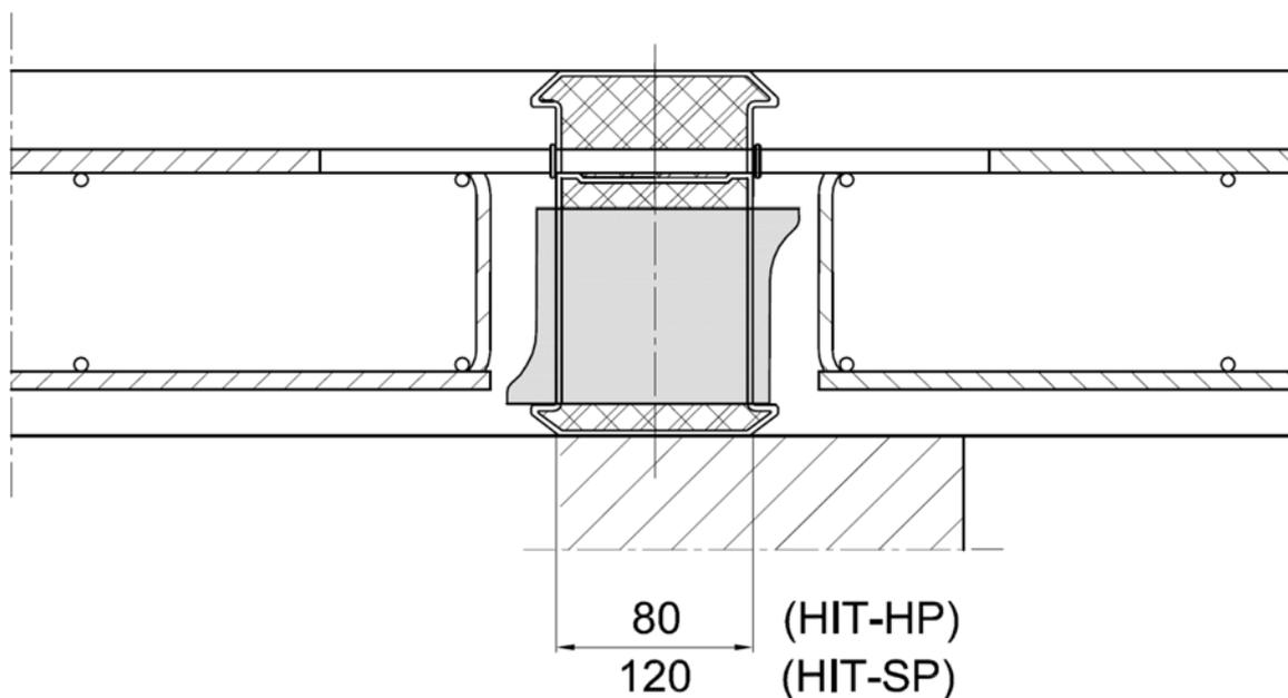
Bild 5: Halfen-Iso-Element **HIT-HP/SP MV F 120-AB / REI 120** im eingebauten Zustand
