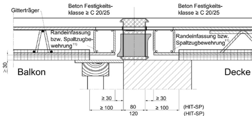
Bild 31: Beispiel für den Anschluss HIT-HP/SP MV F 120-AB/REI 120 an Elementplatten mit statisch - wirksamer Ortbetonschicht
