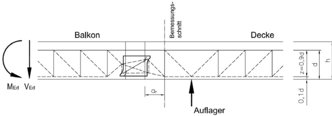
Bild 16: Fachwerkmodell und Bemessungsschnitt **HIT-HP/SP MV** mit Druckschublager
