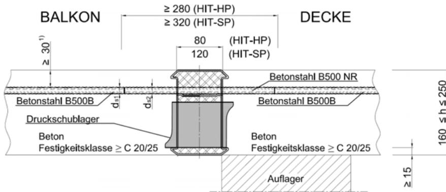
Bild 2: Halfen-Iso-Element **HIT-HP/SP MV F 120-AB /REI 120** im eingebauten Zustand
