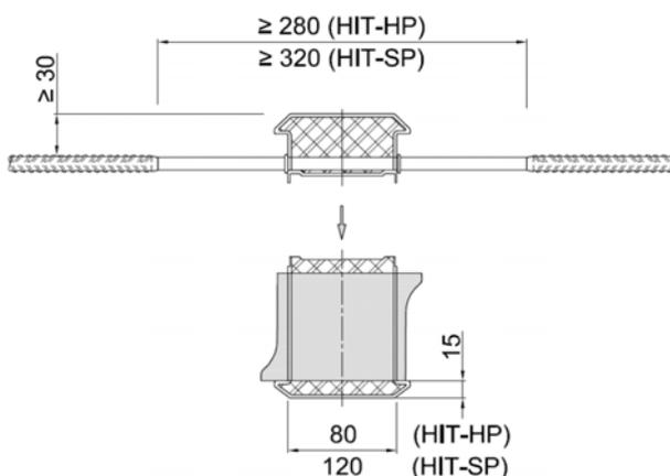
Bild 11: Halfen-Iso-Element HIT-HP/SP MV F 120-AB/REI 120
