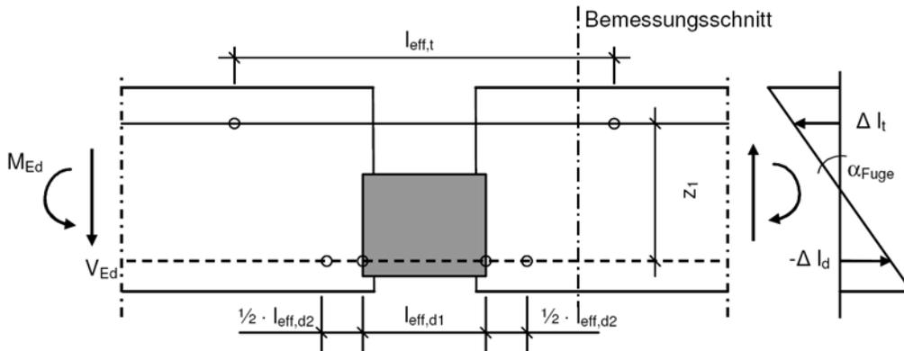
Bild 23: Modell für die Ermittlung der Biegeverformungen in der Fuge
