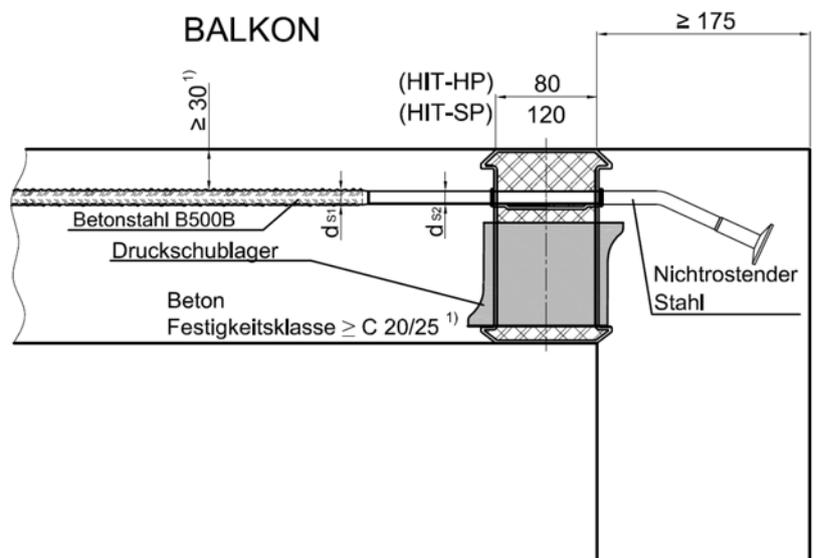
Bild 9: Halfen-Iso-Element **HIT-HP/SP MV-...-WU** F 120-AB /REI 120 im eingebauten Zustand
