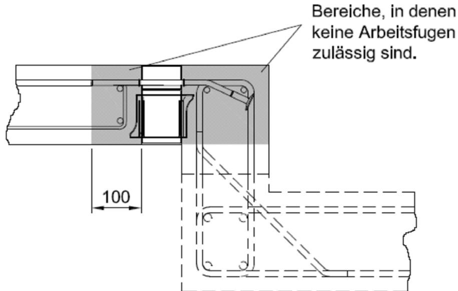
Bild 21a: Bewehrungsführung für HIT HP/SP MV -OU, -WU, Bewehrung der sich anschließenden Deckenplatte bzw. Wand nach DIN 1045-1 bzw. DIN EN 1992-1-1, Lage der Arbeitsfugen
