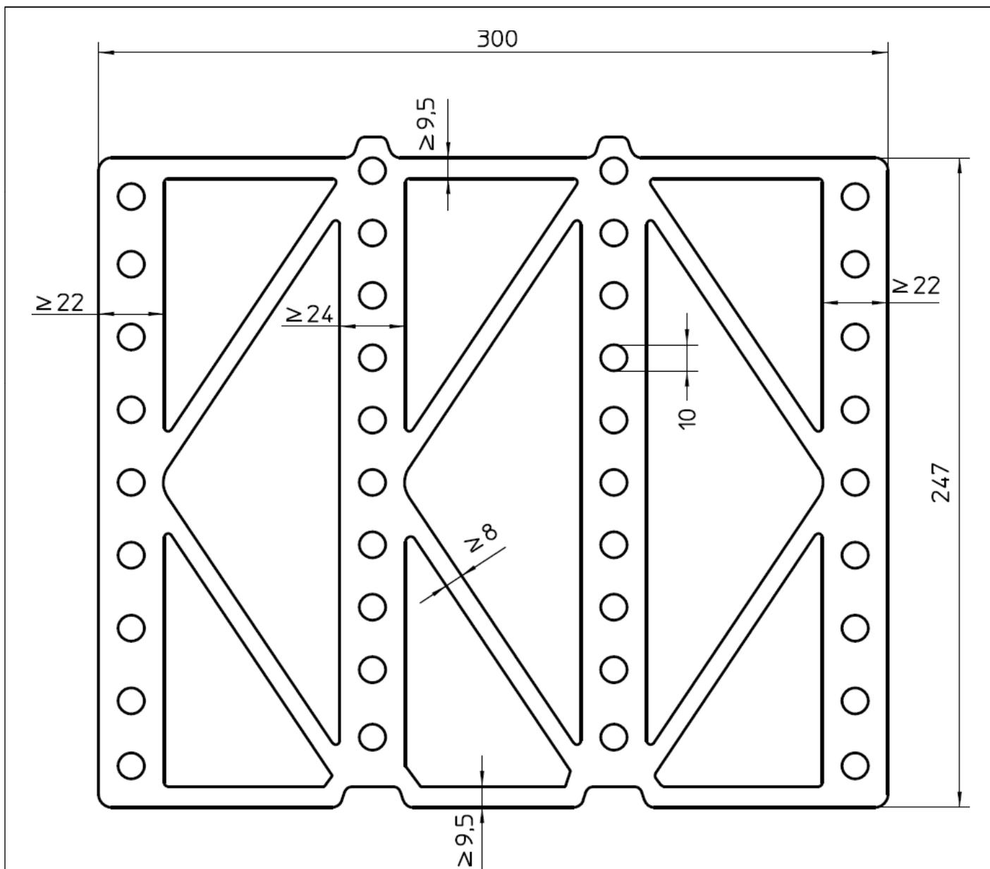
Mauerwerk aus Planhochlochziegeln mit integrierter Wärmedämmung - bezeichnet als ZMK X6 bzw. ZMK X6,5 Planhochlochziegel -
