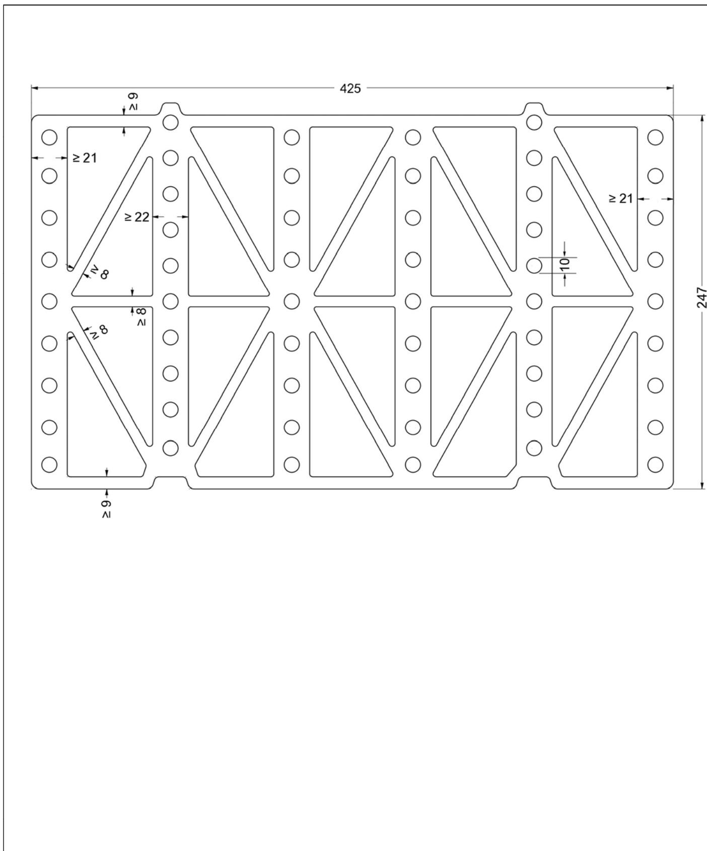
Mauerwerk aus Planhochlochziegeln mit integrierter Wärmedämmung
