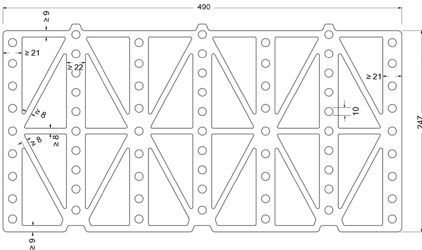
Mauerwerk aus Planhochlochziegeln mit integrierter Wärmedämmung
