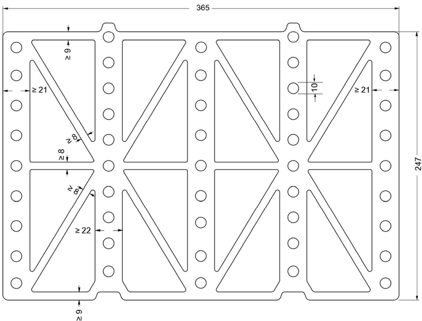
Mauerwerk aus Planhochlochziegeln mit integrierter Wärmedämmung
