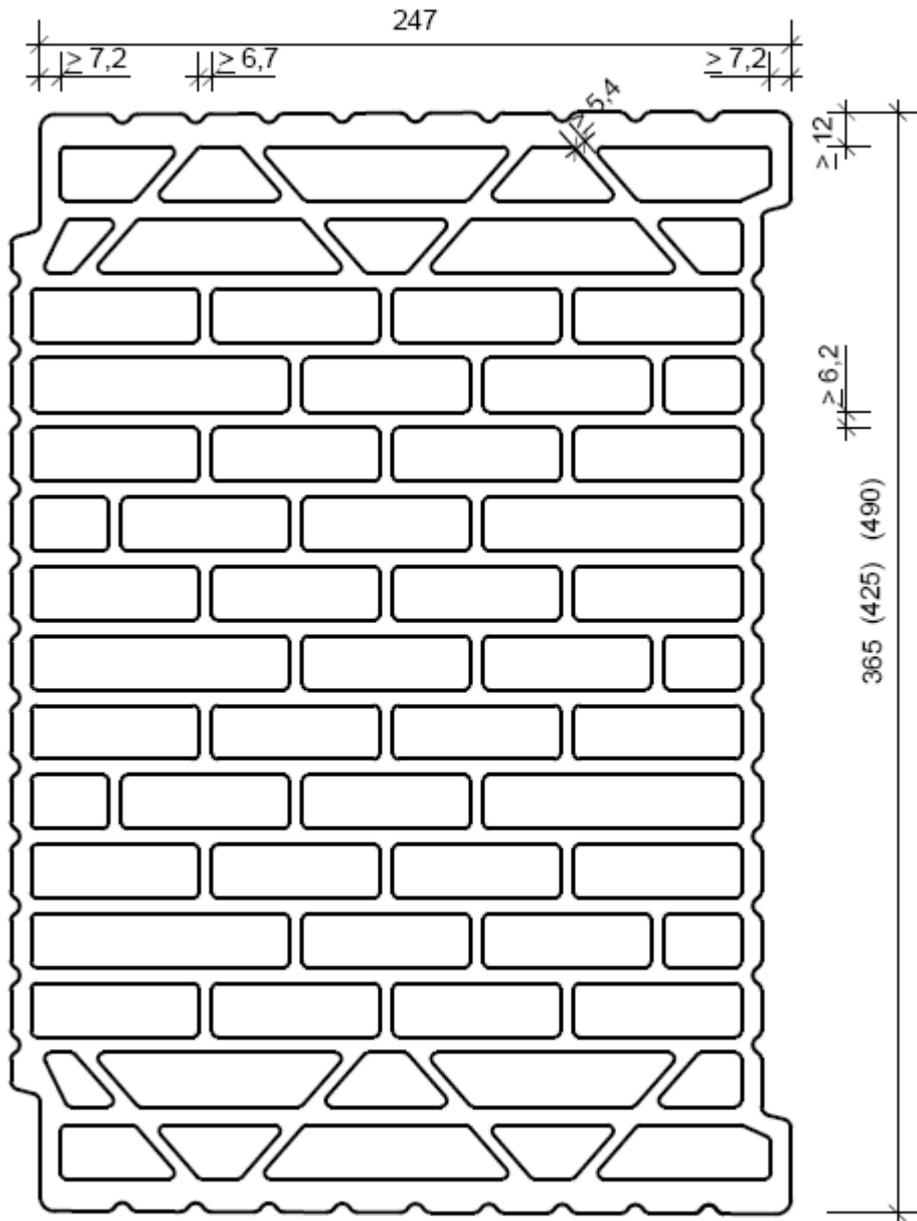
Mauerwerk aus UNIPOR WS07 CORISO Planziegeln
