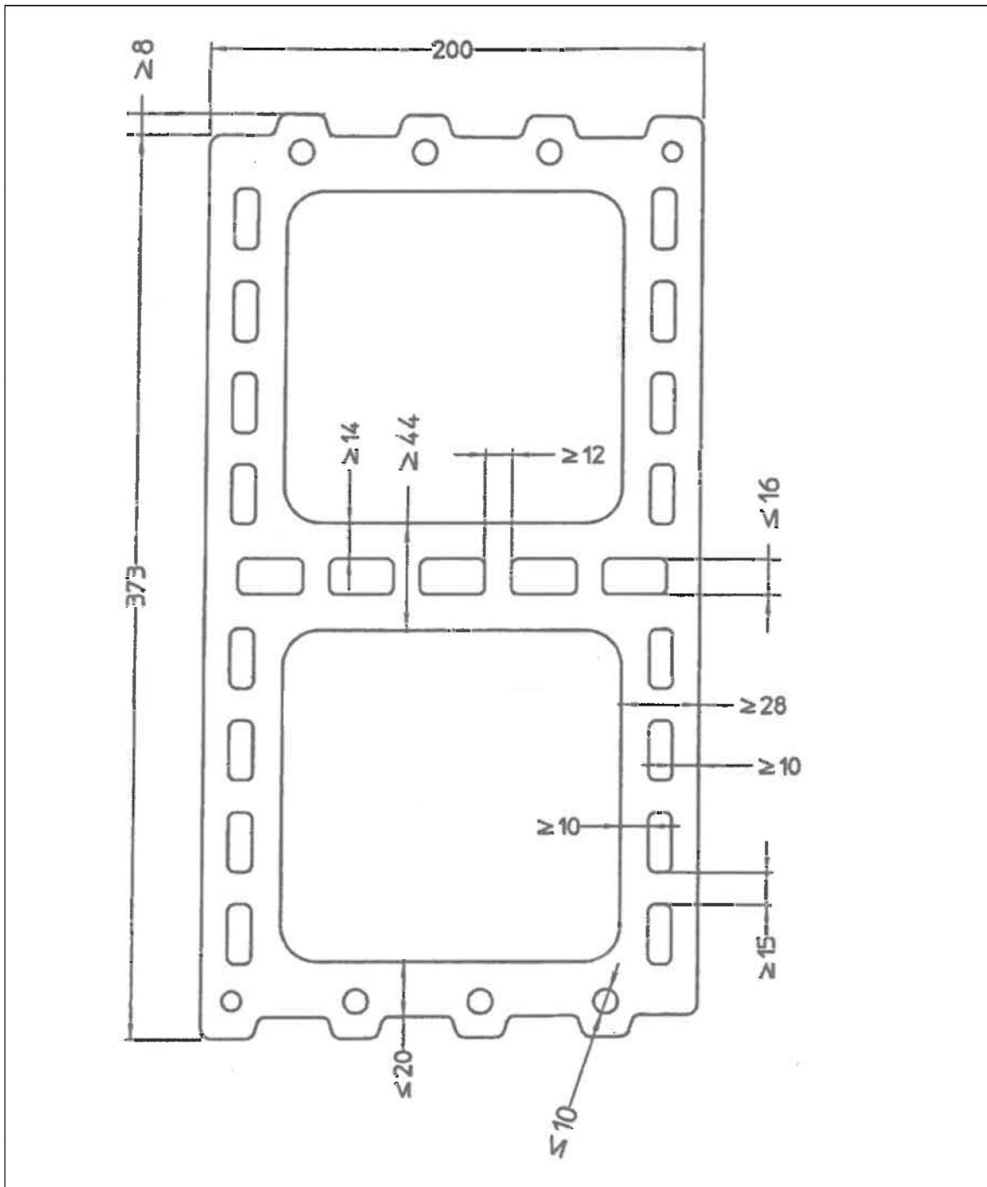
Mauerwerk aus Ott Plan-Füllziegeln
