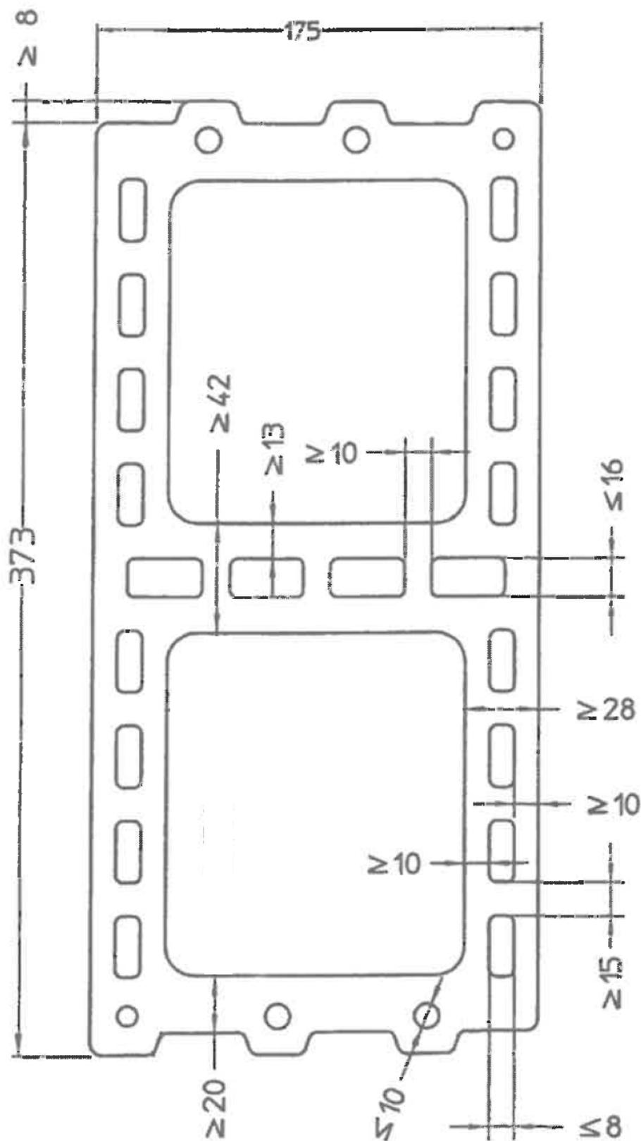
Mauerwerk aus Ott Plan-Füllziegeln
