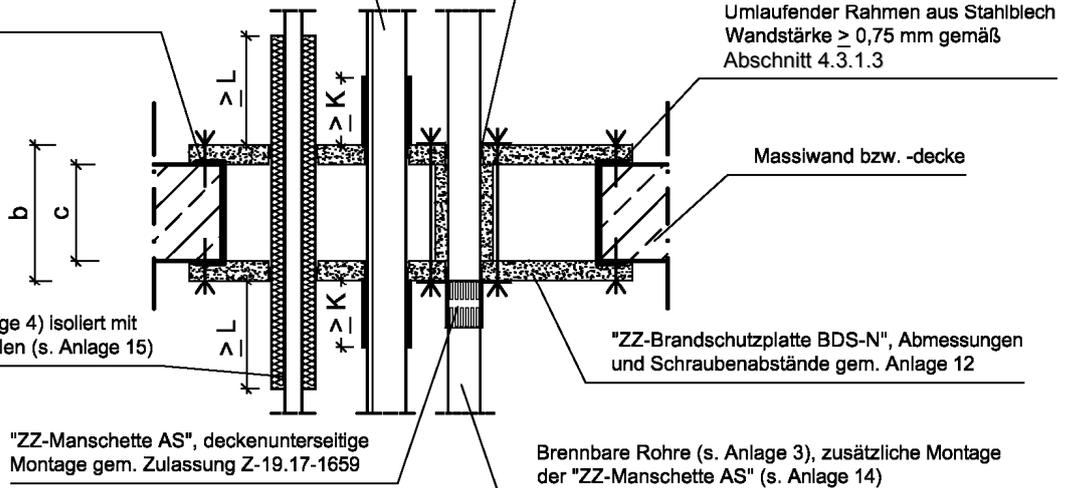
Nichtbrennbare Röhre (s. Anlage 4) isoliert mit Mineralfasermatten oder -schalen (s. Anlage 15)
