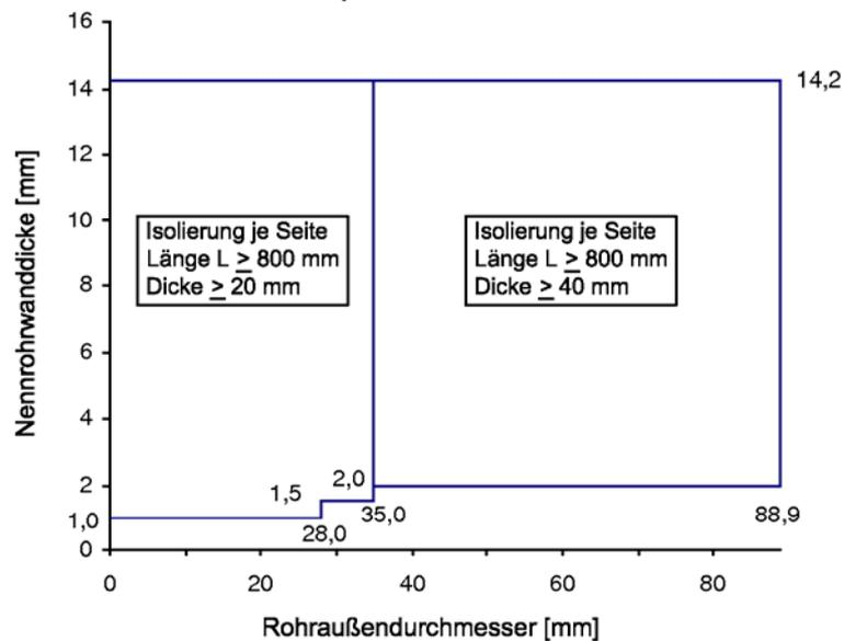
Für die Rohrinsolierung müssen nichtbrennbare (Baustoffklasse DIN 4102-A) Mineralfasermatten oder Mineralfaserschalen gemäß Abschnitt 2.1.5 verwendet werden, deren Schmelzpunkt über 1000 °C liegen muss. Die Nennrohdichte muss mindestens 90 kg/m<sup>3</sup> betragen.
