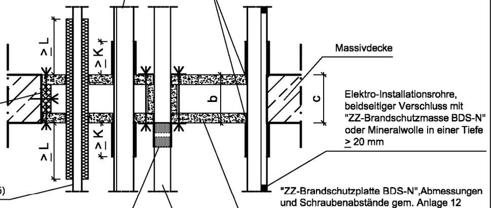
Nichtbrennbare Rohre (s. Anlage 4) isoliert mit Mineralfasermatten oder -schalen (s. Anlage 15)
