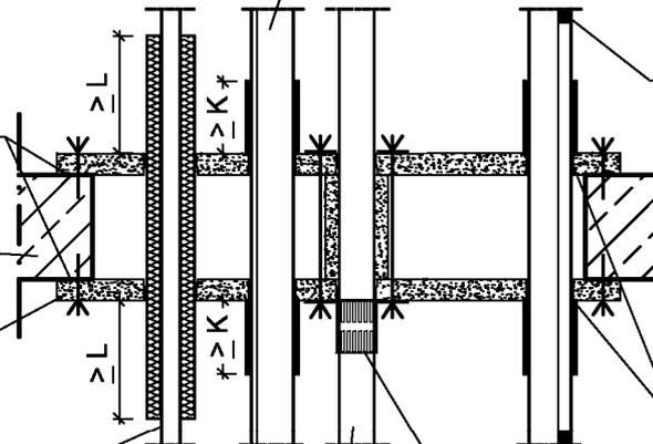
Fugen und Zwicke mit "ZZ-Brandenschutzmasse BDS-N"  $\geq 3$  cm tief verfüllen
