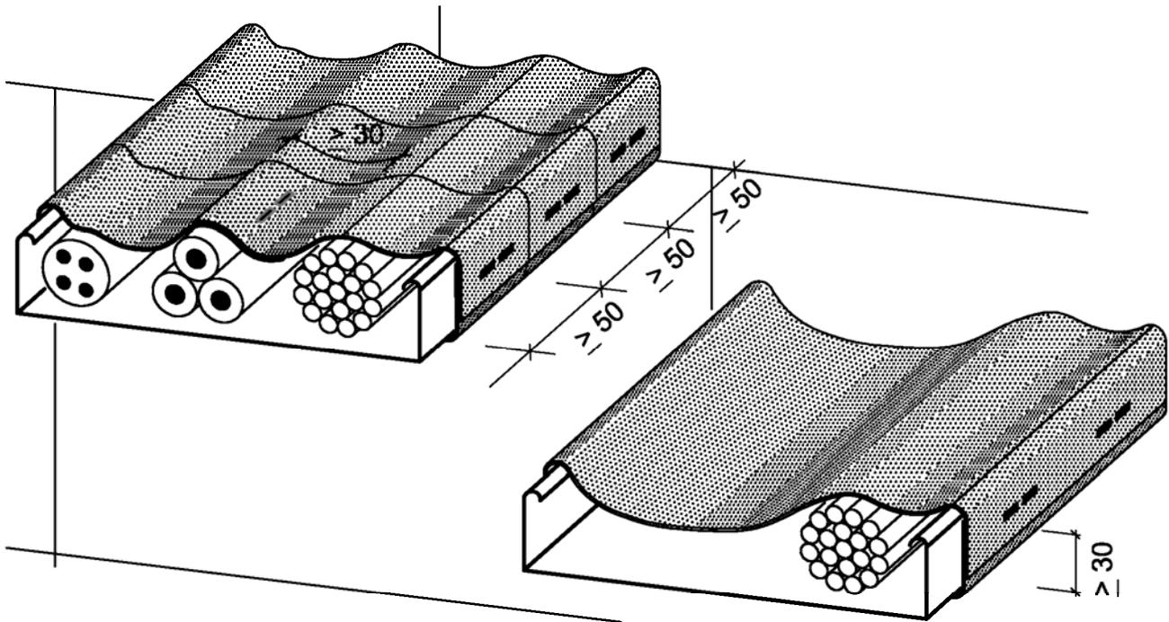
Kabel (in Abhängigkeit vom Kabeldurchmesser), Kabelbündel, Steuerleitungen und Elektroinstallationsrohre sowie die zugehörigen Kabeltragekonstruktionen müssen auf beiden Seiten der Kabelabschottung mit Streifen aus dem dämmschichtbildenden Baustoff, "ZZ-Kabelwickel BDS-N" genannt, profilfolgend umwickelt werden (s. Abschnitt 4.4.1).
