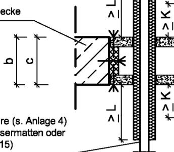
Nichtbrennbare Rohre (s. Anlage 4) isoliert mit Mineralfasermatten oder -schalen (s. Anlage 15)
