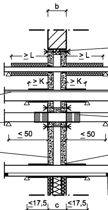
Leisten aus nichtbrennbaren Bauplatten (Dicke  $\geq 2 \times 12,5$  mm bzw.  $\geq 25$  mm), wahlweise in Bauteillaibung verschraubt oder mit "ZZ-Brandschutzmasse BDS-N" verklebt, Abdichtung zwischen Leiste und "ZZ-Brandschutzplatte BDS-N"/Wand mit "ZZ-Brandschutzmasse BDS-N"
