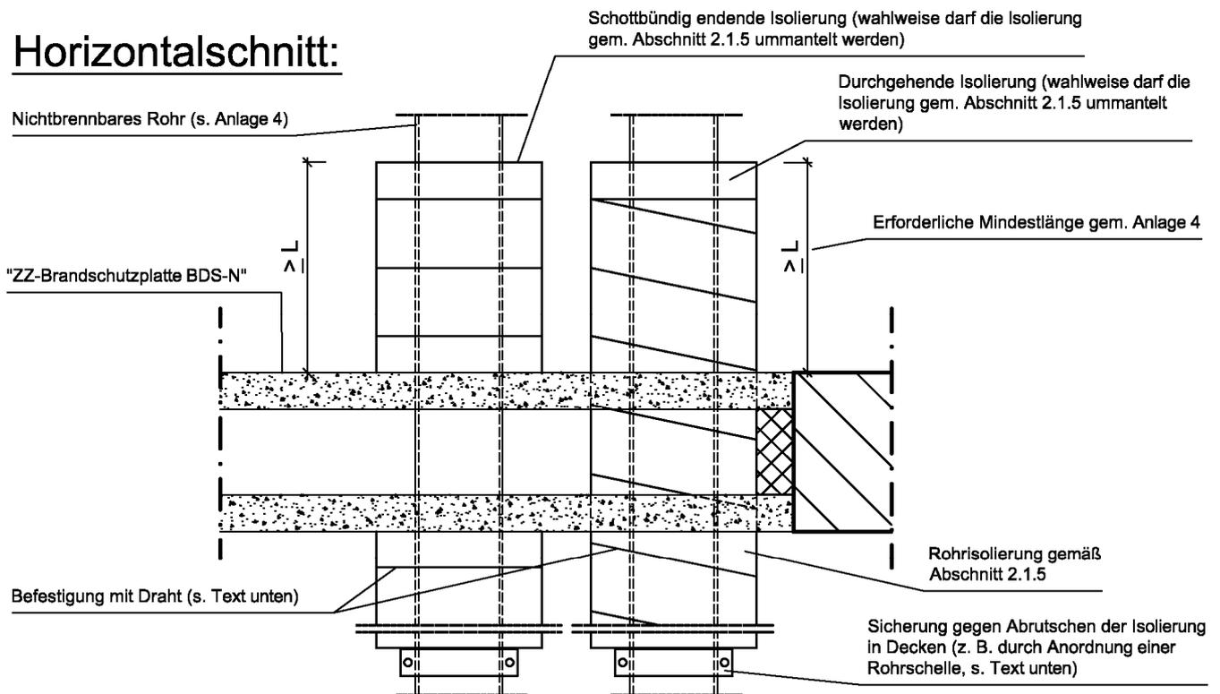
Die Rohrisolierungen müssen mit mindestens 0,6 mm dicken Draht mit 6 Wicklungen pro lfd. Meter befestigt werden und dürfen wahlweise durch die Abschottung hindurchgeführt werden oder an der Schottoberfläche enden. In Decken ist die Isolierung gegen Abrutschen zu sichern (z. B. durch eine auf dem Rohr montierte Rohrschelle).
