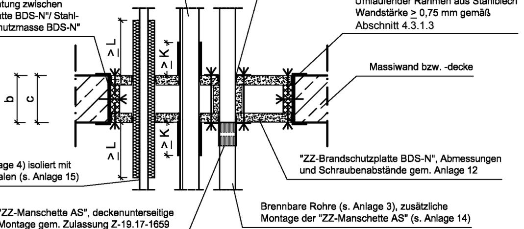
Nichtbrennbare Röhre (s. Anlage 4) isoliert mit Mineralfasermatten oder -schalen (s. Anlage 15)
