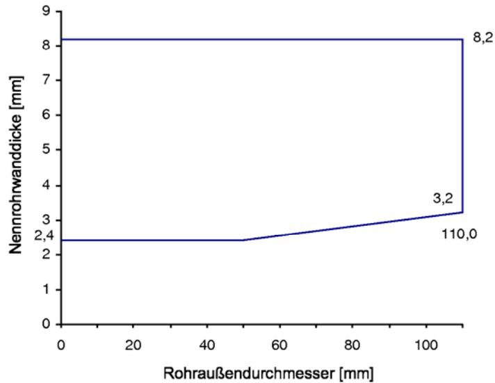
**Rohre der Rohrgruppe B gemäß Anlage 1**
