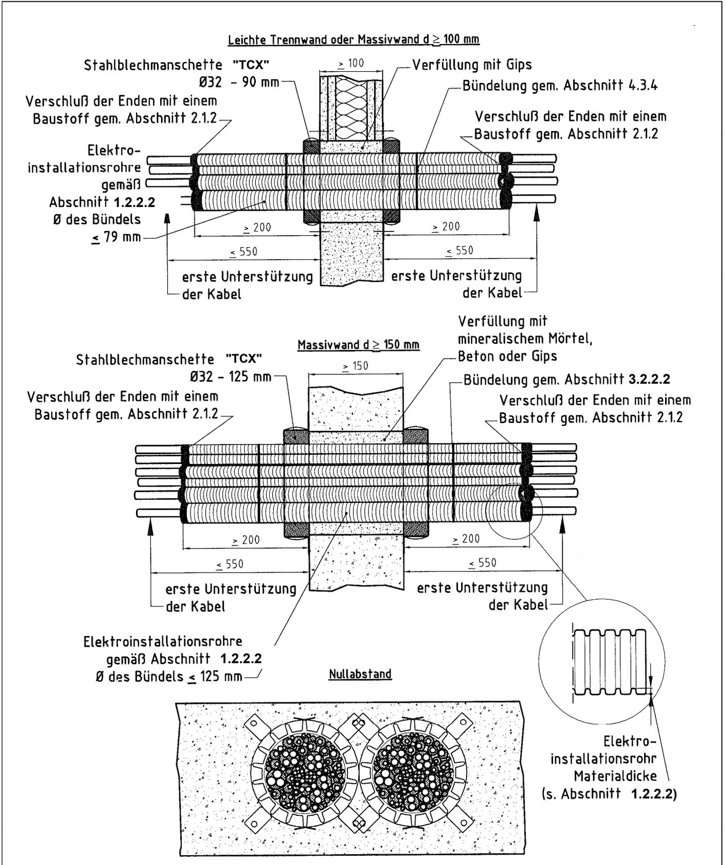
Kabelabschottung "System PYROCOMB Tubes"
