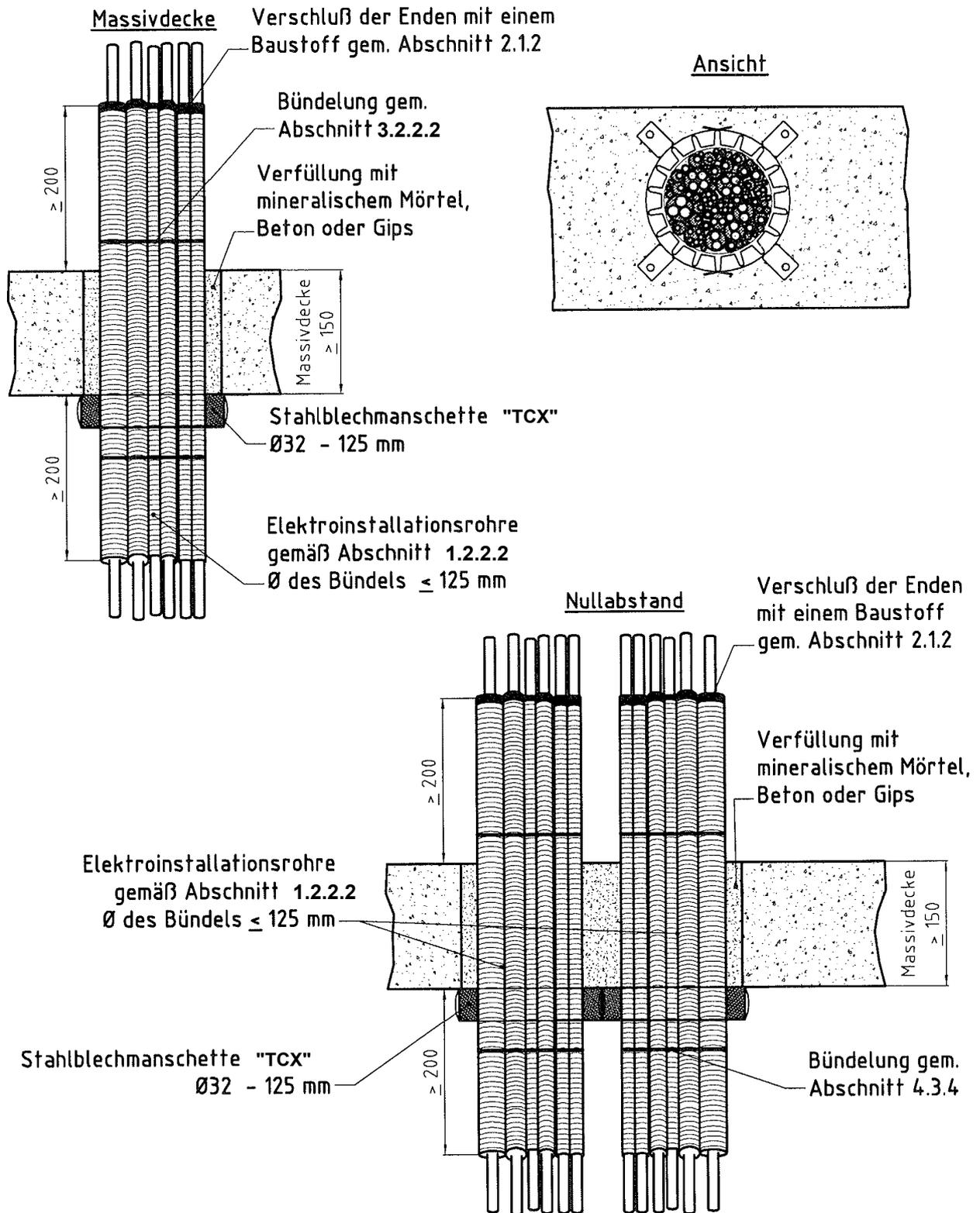
Kabelabschottung "System PYROCOMB Tubes"
