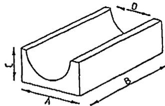
Packstücke sind Halbschalen mit einer Nut passend zum AD der abzudichtenden Leitung
