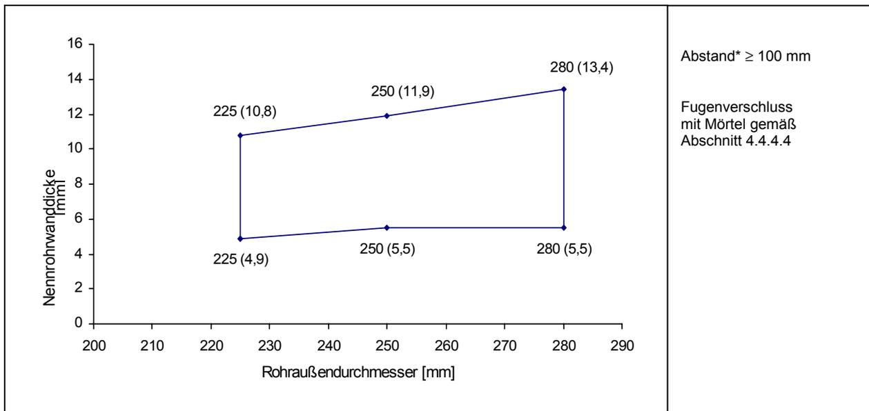
**Rohre gemäß Rohrgruppe A-7:** (Rohrmanschette "TCX MAX", Rohre mit Synthese-Kautschuk-Isolierung, senkrecht zur Bauteiloberfläche durchgeführte Rohre, aufgesetzte Manschetten)
