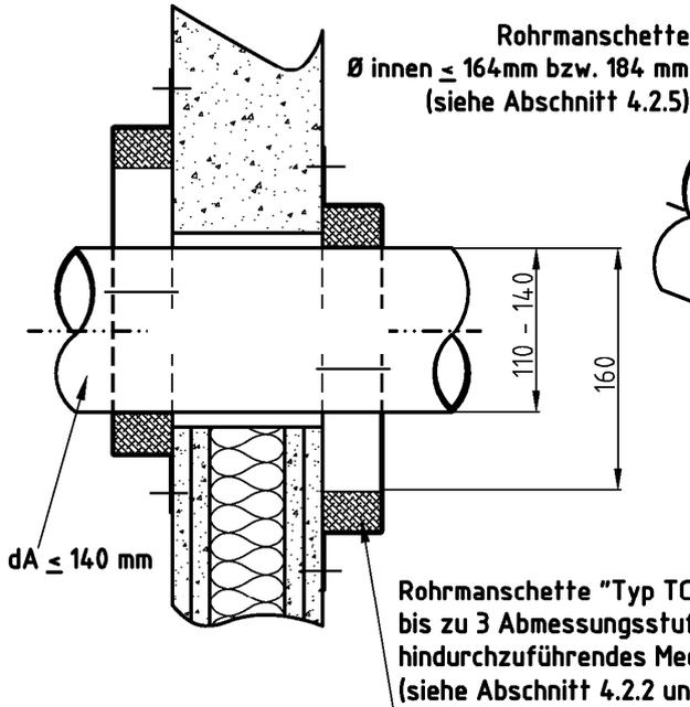
**Schräge Rohrdurchführung (Rohrgruppen A-1, A-9, B-1, B-9, C und G)**
