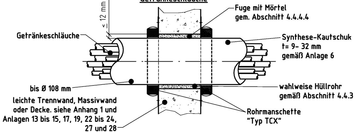
Rohrabschottung "System PYROCOMB"
