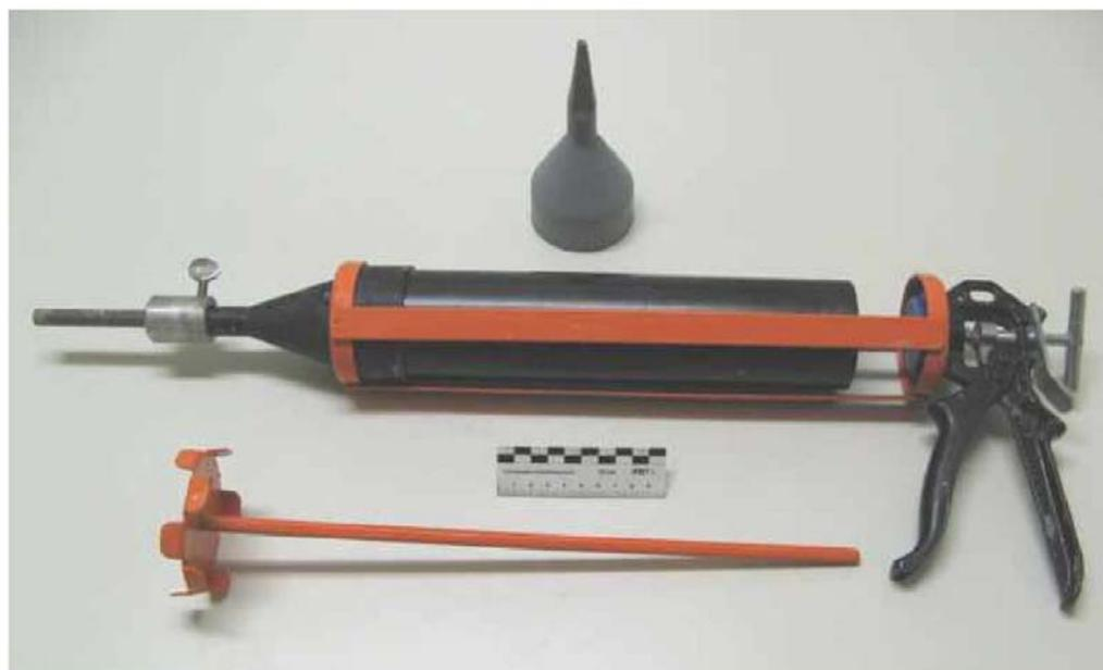
**Brutt Saver Luftschichtanker zur nachträglichen Verankerung im Mauerwerk**
