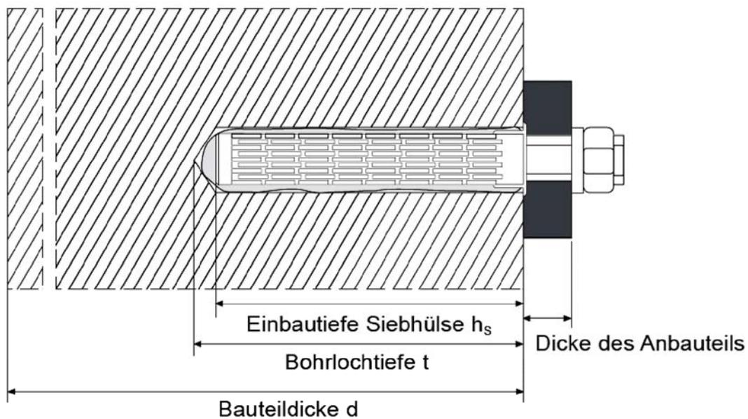
Sympafix Verbundankersystem C100-PLUS zur Verankerung im Mauerwerk
