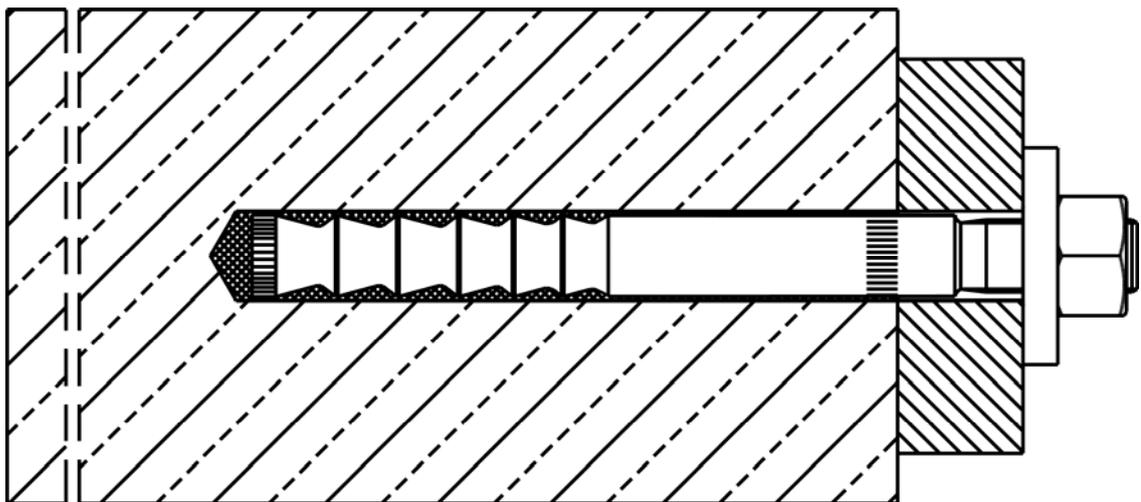
**MKT Injektionssystem VMZ für Befestigungen in Kernkraftwerken und anderen kerntechnischen Anlagen**
