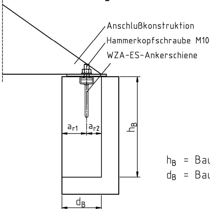
Querschnitt ohne Ziegelschale
