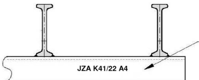
Die Kennzeichnung ist dauerhaft auf dem Schienenrücken (innen oder außen) bzw. auf dem Schienensteg vorzunehmen. Sie kann mittels Aufkleber, Aufdruck, Prägung oder anderer geeigneter Maßnahmen erfolgen.
