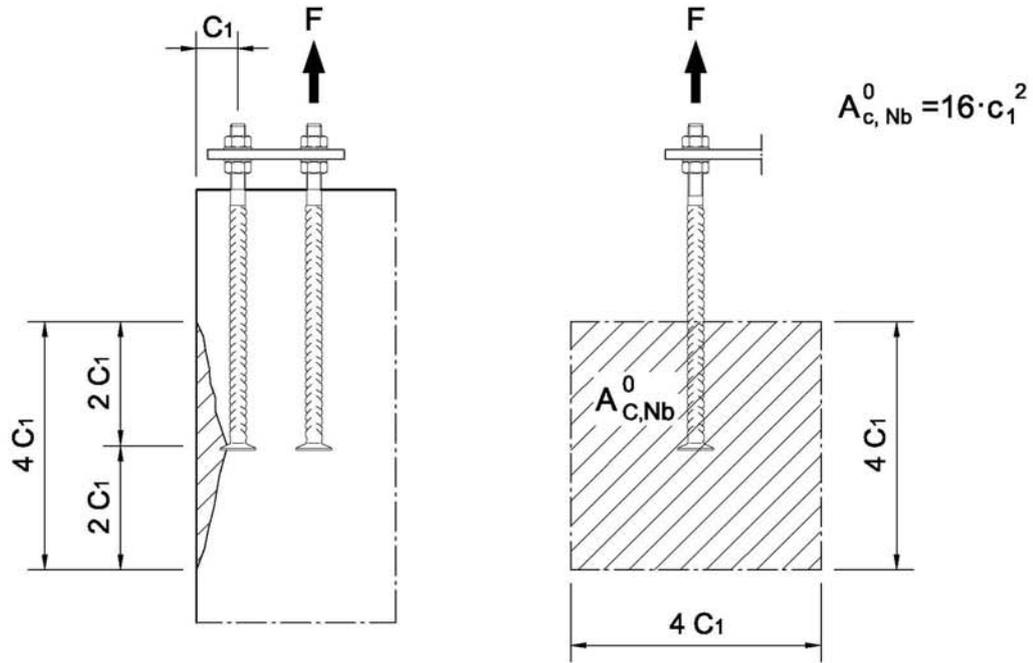
**Bild 5: Beispiel für vorhandene Fläche  $A_{c, Nb}$  des Ausbruchkörpers bei lokalem Betonausbruch am Bauteilrand**
