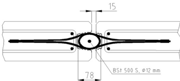
Bild 13: Minimale Fugenbreite
