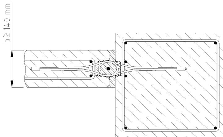
Bild 6: Stützen - Wandverbindung
