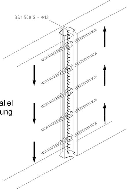
Bild 18: Beanspruchung parallel zur Fugenlängsrichtung
