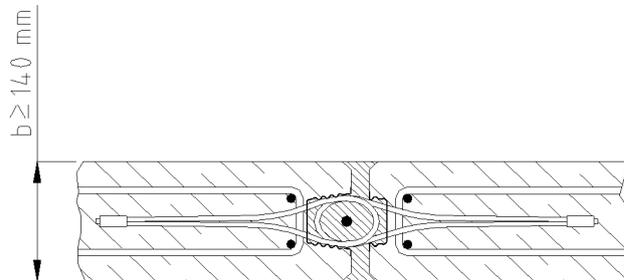
Bild 5: Wand - Wandverbindung
