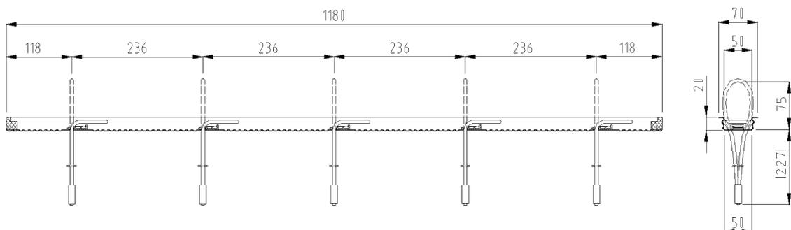
Bild 3: VS<sup>®</sup>-ISI-20 (Längs- und Querschnitt)
