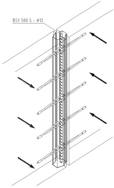
Bild 19: Beanspruchung senkrecht zur Fugenlängsrichtung und Wandebene
