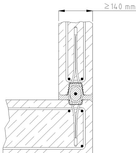
Bild 7: Wand - Wand – Eckverbindung - Regeldetail
