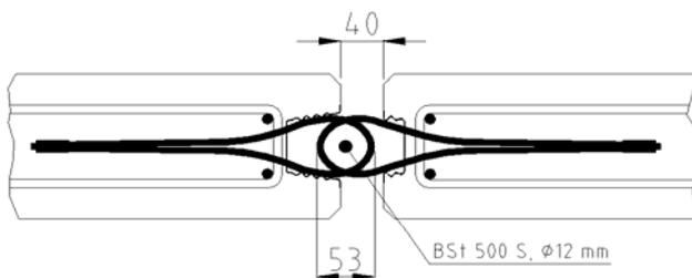
Bild 14: Maximale Fugenbreite
