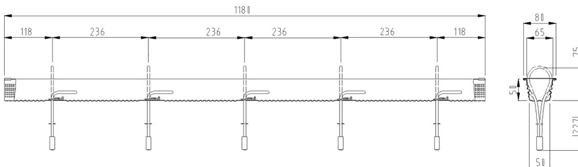
Bild 1: VS<sup>®</sup>-ISI-50 (Längs- und Querschnitt)
