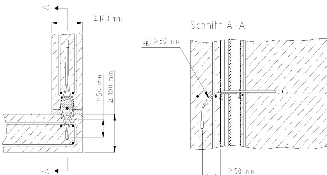
Bild 8: Wand - Wand – Eckverbindung - Detail bei abgewinkelter Seilschlaufe
