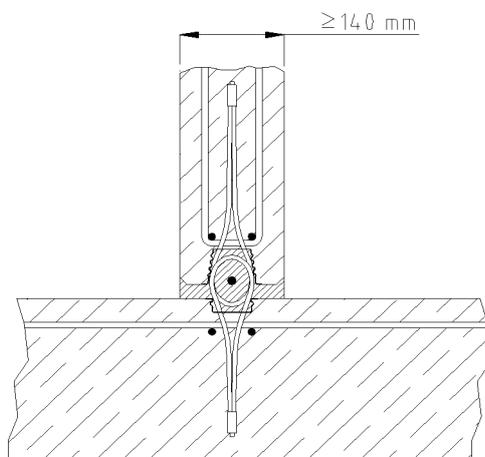
Bild 9: Wand - Wand – T-Verbindung - Regeldetail
