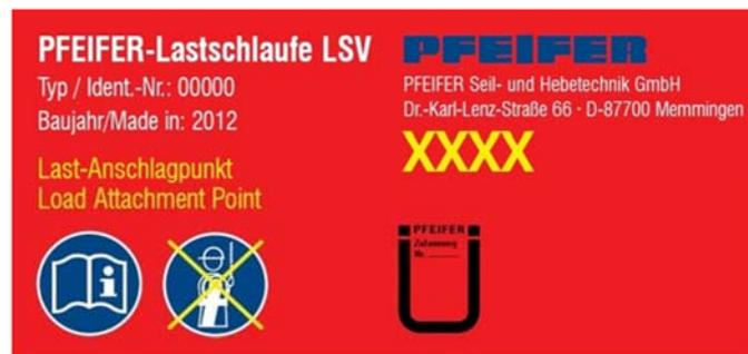
Kennzeichnung der Lastschleife LSV (XXXX = Typkennzeichnung/Lastklasse)
