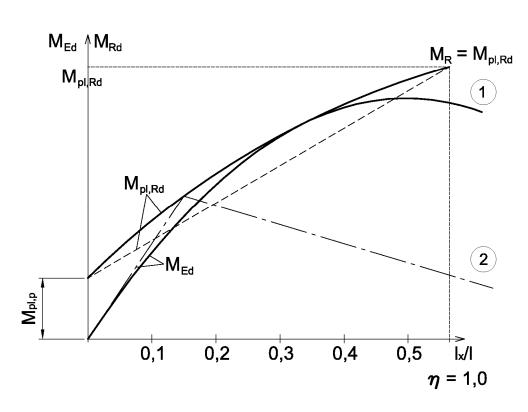
Schubübertragungslänge Isf bei  $\eta$  = 1,0: Isf =  $\frac{A_{pe} \cdot f_{yp,d}}{T_{u,Rd} \cdot b}$
