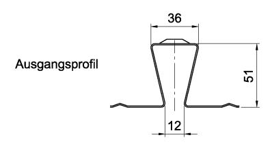
Die Blechverformungsanker werden in der Regel im Herstellwerk maschinell geformt.
