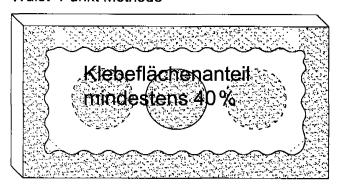
Randverklebung als Wulst, zusätzlich Punkte oder Stege zur Aussteifung
