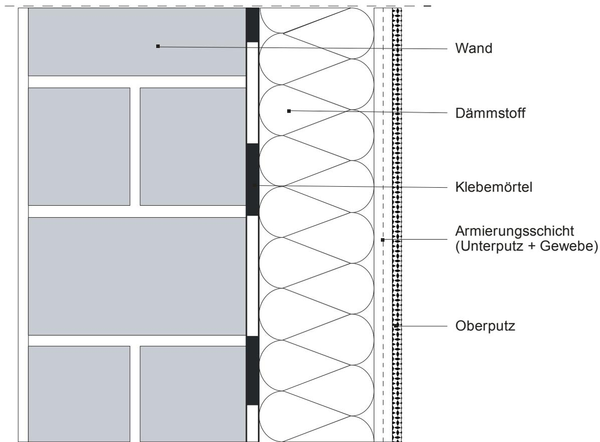
Wärmedämm-Verbundsystem mit angeklebten Dämmplatten aus expandiertem Polystyrol
