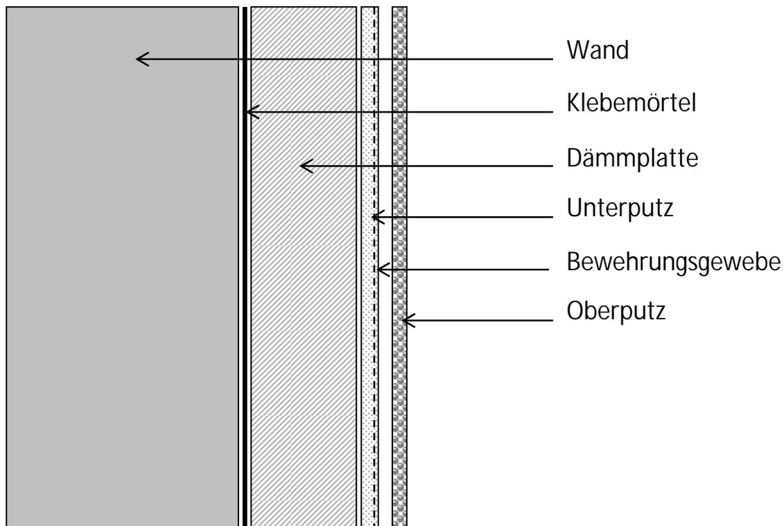
Wärmedämm-Verbundsystem mit angeklebten Dämmplatten aus expandiertem Polystyrol
