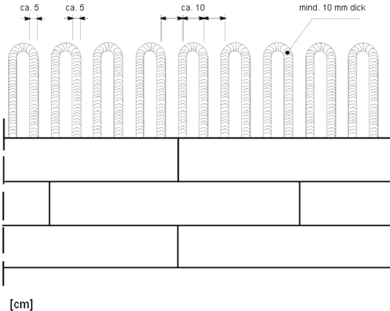
Wärmedämm-Verbundsystem mit angeklebten und angedübelten Dämmplatten
