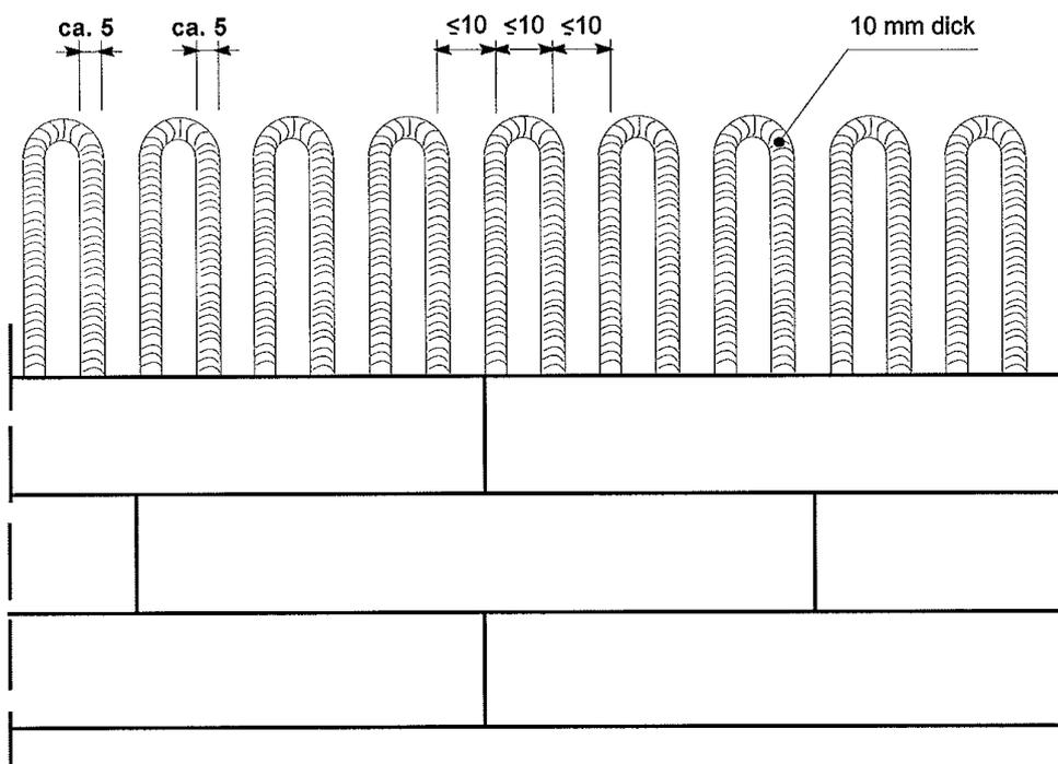
Wärmedämm-Verbundsystem mit angeklebten Mineralwolle-Lamellen
