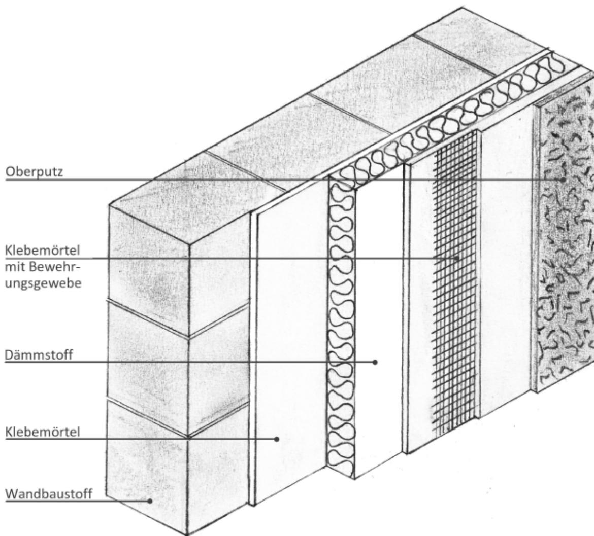
Der Dämmstoff ist ggf. mit Dübeln mechanisch befestigt.
