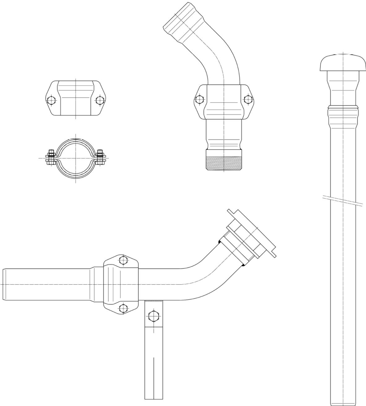
MÖCK Füllleitungen und Be- und Entlüftungsleitungen für Heizöltanks
