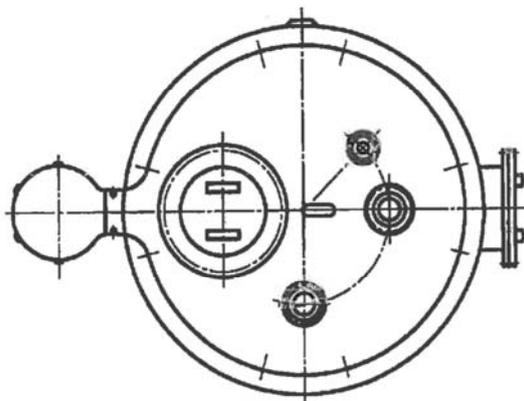
Flachbodenbehälter aus GFK mit innerer Vlies- oder Chemieschutzschicht
