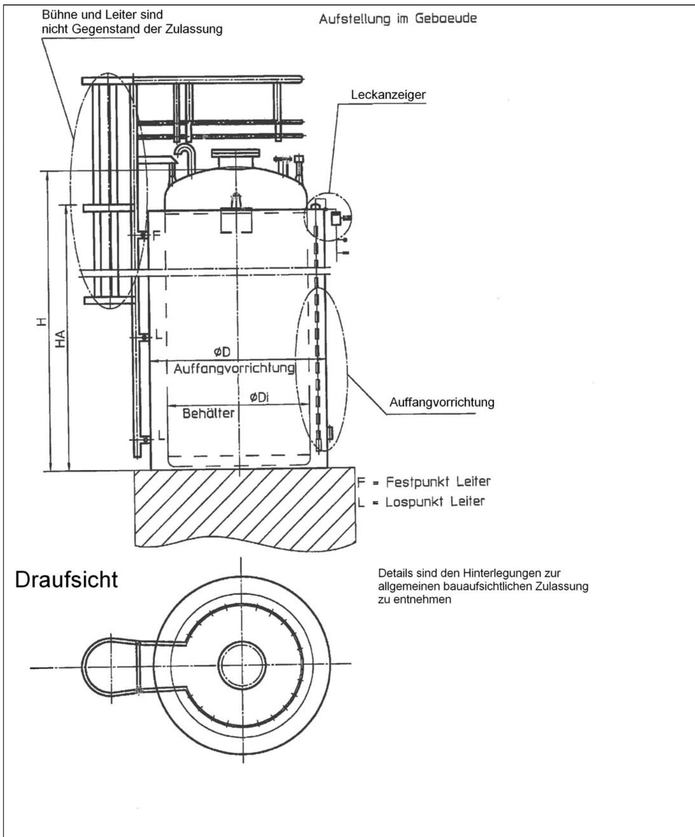
Flachbodenbehälter aus GFK mit innerer Vlies- oder Chemieschutzschicht
