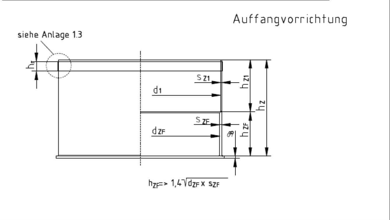
Zylindrische Flachbodenbehälter und Auffangvorrichtung aus Polyethylen (PE 80 und PE 100) mit Zylindermäntel aus verschweißten Tafeln (Tafelbehälter)
