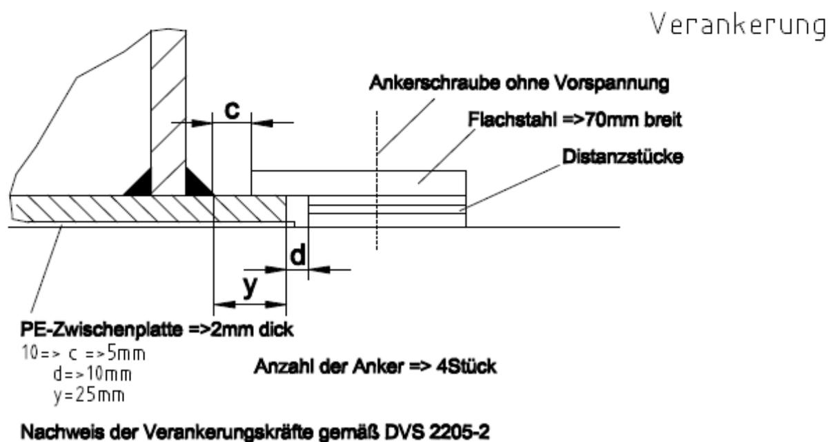
Zylindrische Flachbodenbehälter und Auffangvorrichtung aus Polyethylen (PE 80 und PE 100) mit Zylindermäntel aus verschweißten Tafeln (Tafelbehälter)
