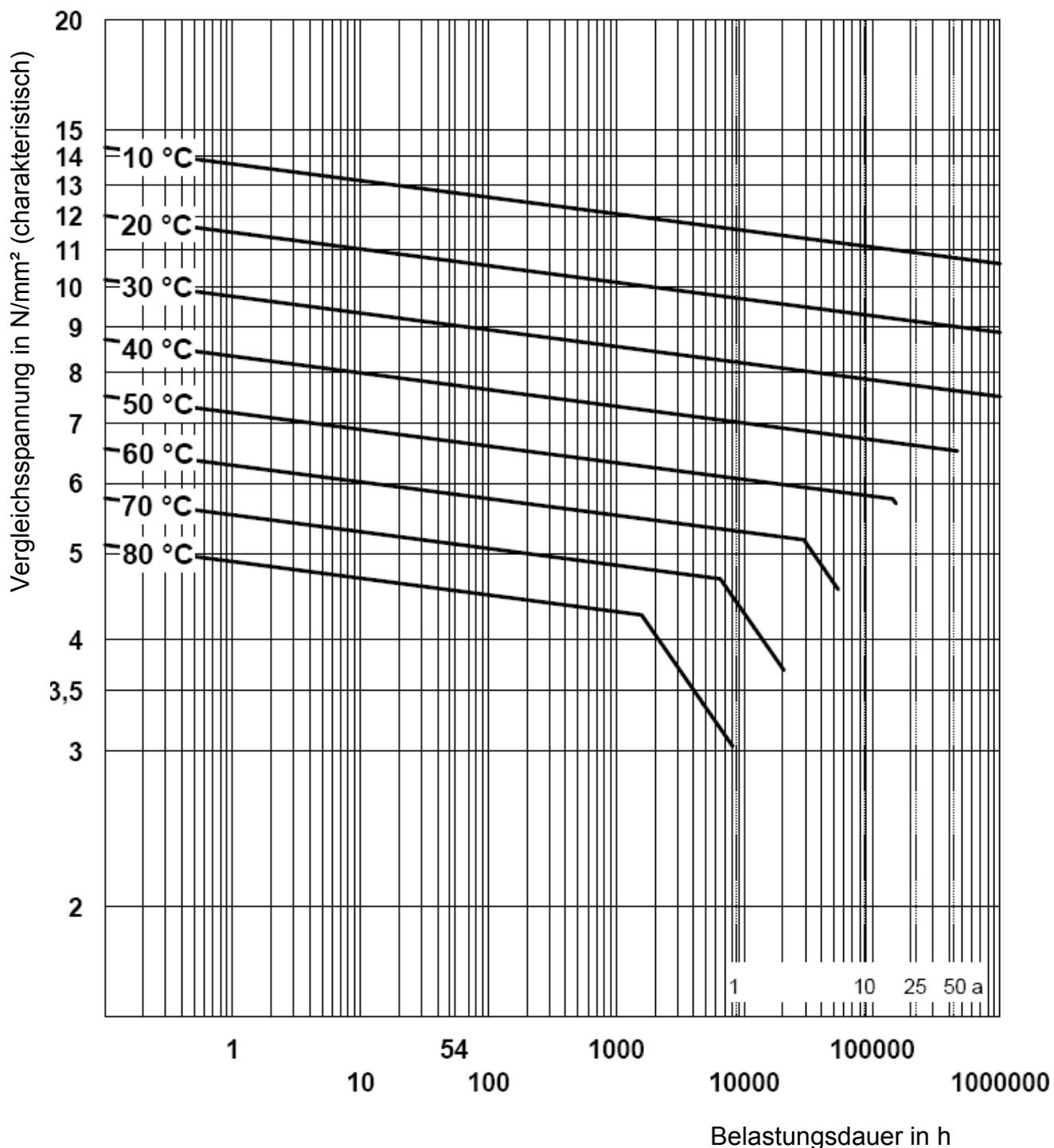
Formmassen aus Polyethylen (PE-LMD),
