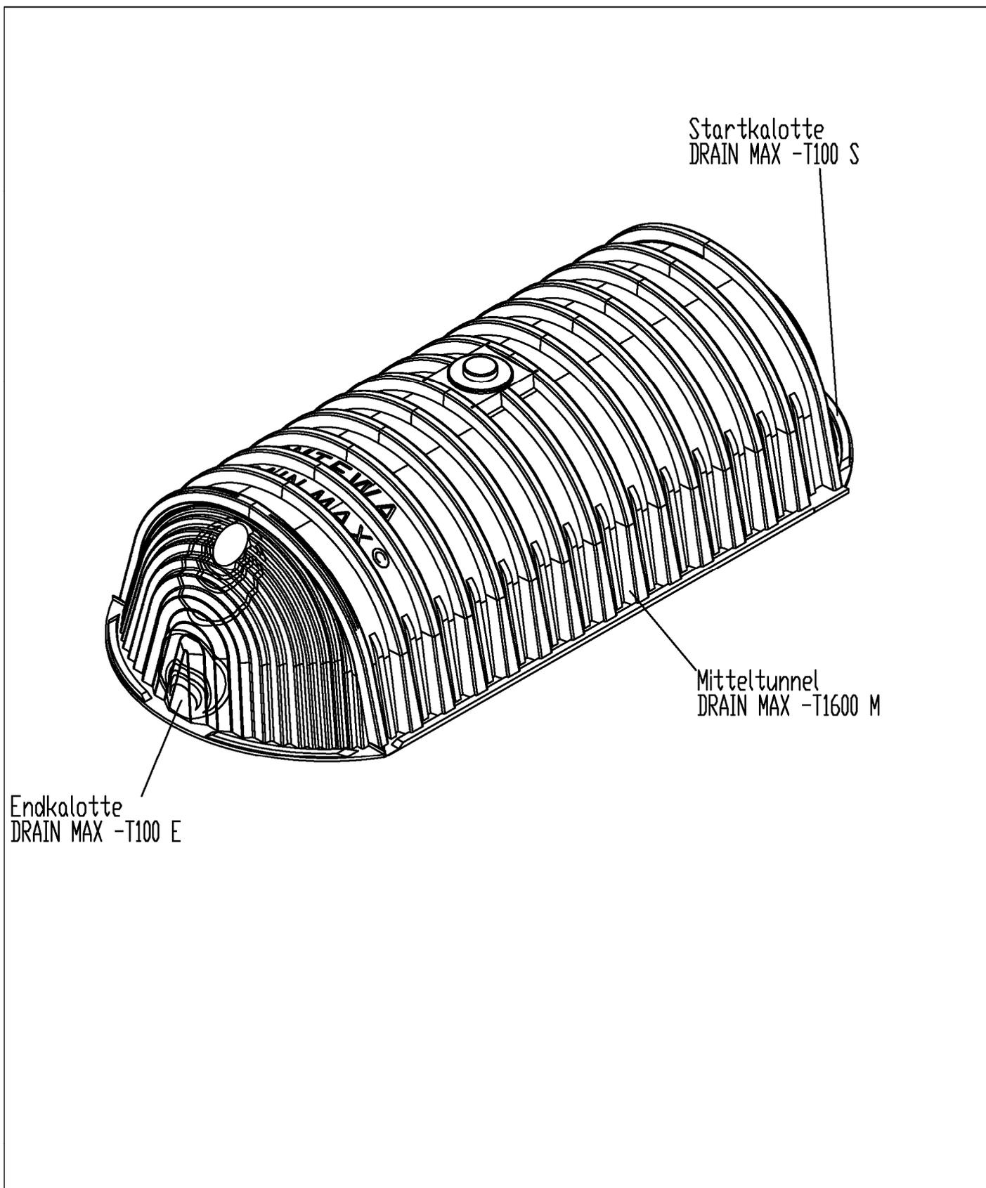
Tunnelsystem für die Versickerung von Niederschlagswasser mit der Bezeichnung "DRAIN MAX" aus HD-PE
