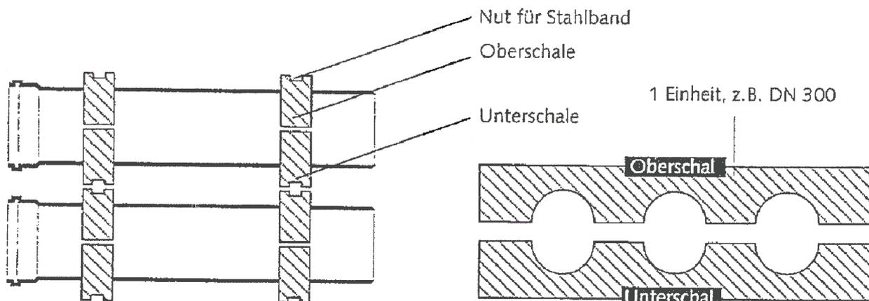
Die hier dargestellten Palettenhölzer (Oberschale/ Unterschale) bilden eine Einheit. Die Einheiten werden mit Stahlband zusammengehalten. Für jede Rohrmennweite gibt es spezielle Ober- und Unterschalen.
