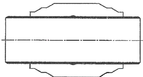
Bei der Herstellung von Gelenkstücken (spitz/ Spitz) werden in der Mitte des Inliners an der Aussenseite kreisrund vier Keile aus PVC-U (siehe Detail) aufgeklebt, die ein Verschieben des Inliners bei Temperaturschwankungen verhindern. Dies Maßnahme ist nur bei Gelenkstücken spitz/ spitz erforderlich, da sie keine angeformte Muffe haben, die sich im Beton verankert.
