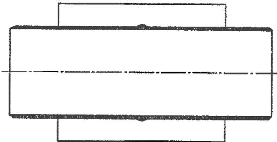
Bei der Herstellung von Gelenkstücken (spitz/Spitz) werden in der Mitte des Inliners an der Aussenseite kreisrund vier Keile aus PVC-U (siehe Detail) aufgeklebt, die ein Verschieben des Inliners bei Temperaturschwankungen verhindern. Diese Maßnahme ist nur bei Gelenkstücken spitz/ spitz erforderlich, da sie keine angeformte Muffe haben, die sich im Beton verankert.
