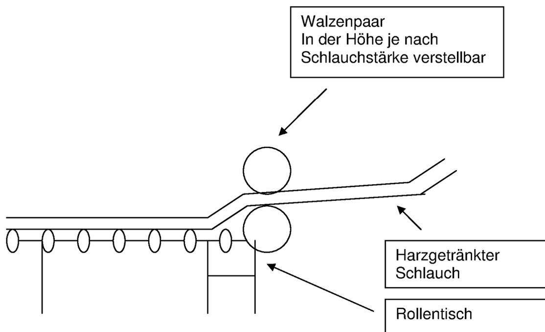
Schlauchlinierverfahren mit der Bezeichnung "lineTEC ProFlex" zur Sanierung von erdverlegten schadhafte Abwasserleitungen
