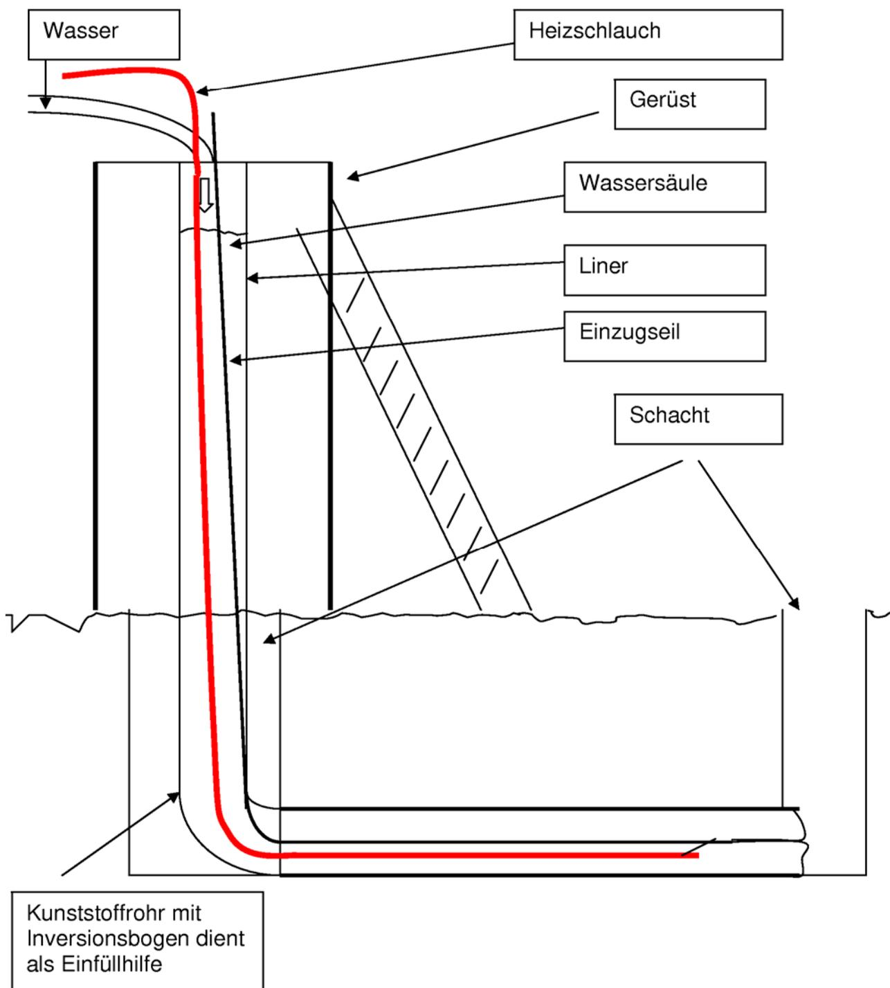
Schlauchlinierverfahren mit der Bezeichnung "lineTEC ProFlex" zur Sanierung von erdverlegten schadhafte Abwasserleitungen
