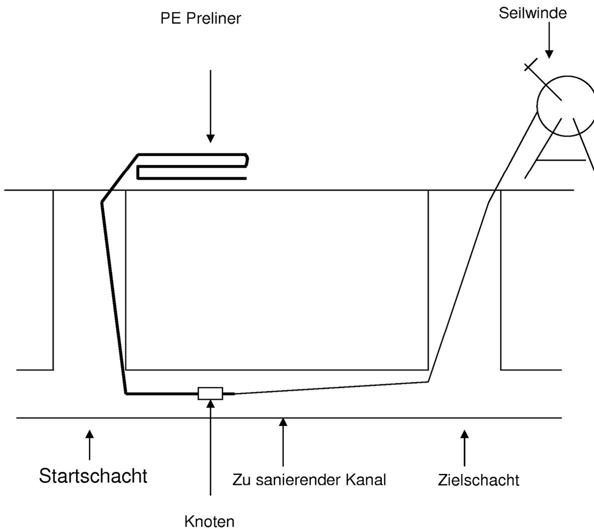
Schlauchliniungsverfahren mit der Bezeichnung "lineTEC ProFlex" zur Sanierung von erdverlegten schadhafte Abwasserleitungen
