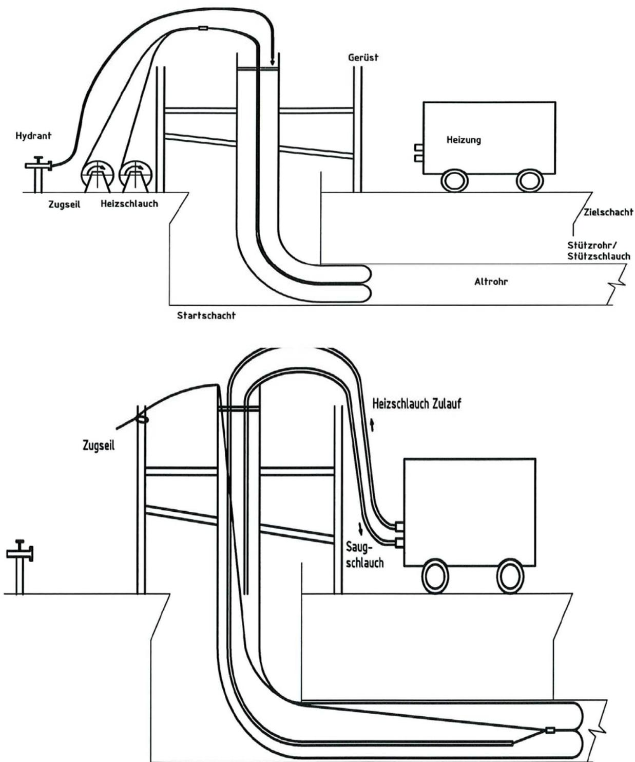
Schlauchlinierverfahren mit der Bezeichnung "lineTEC ProFlex" zur Sanierung von erdverlegten schadhaften Abwasserleitungen
