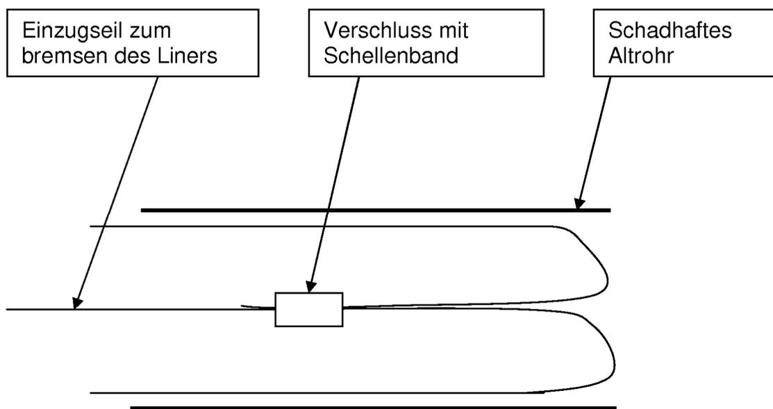
Schlauchlinierverfahren mit der Bezeichnung "lineTEC ProFlex" zur Sanierung von erdverlegten schadhaften Abwasserleitungen
