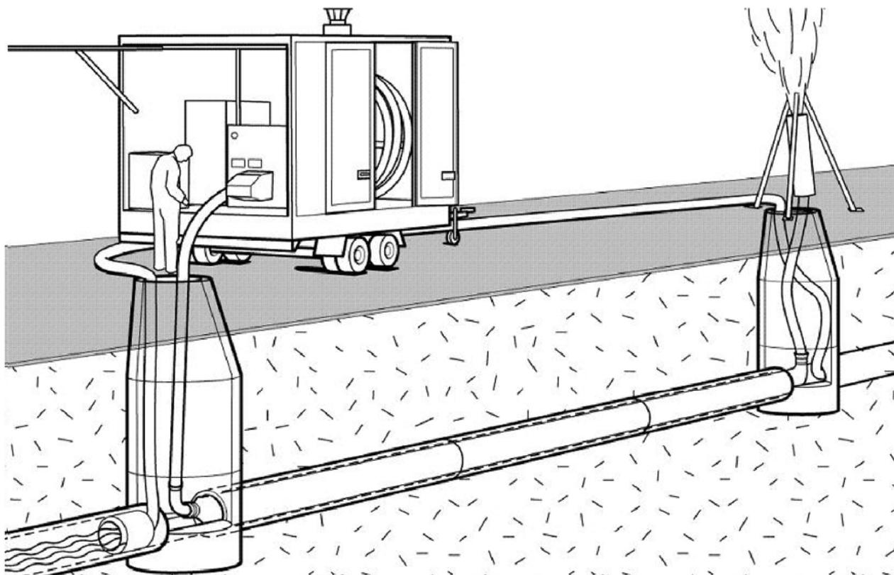
Schlauchlinierverfahren mit der Bezeichnung "lineTEC ProFlex" zur Sanierung von erdverlegten schadhafte Abwasserleitungen
