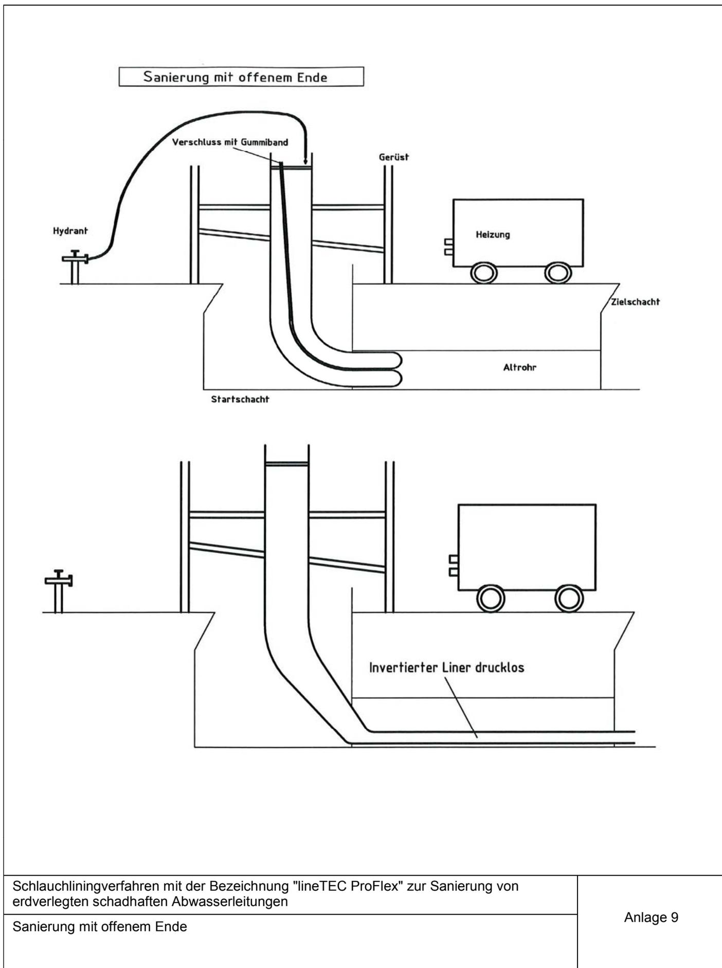
Sanierung mit offenem Ende-Einbringen des Kalibrierschlauches
