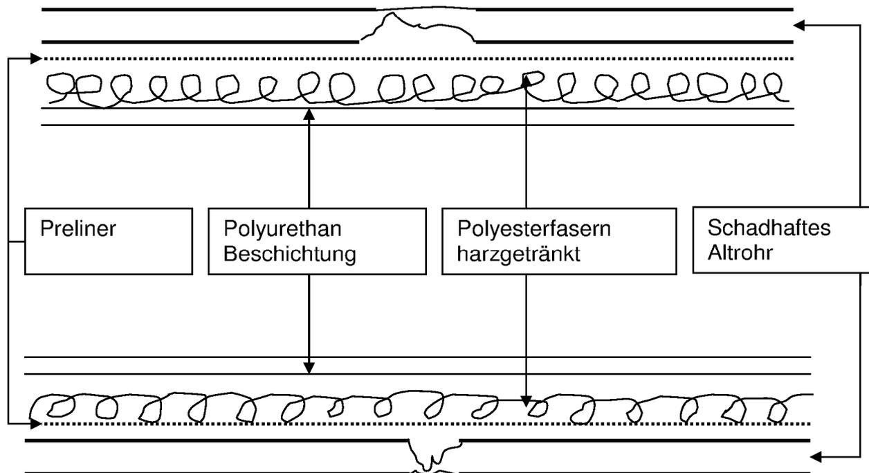
Schlauchlinierverfahren mit der Bezeichnung "lineTEC ProFlex" zur Sanierung von erdverlegten schadhaften Abwasserleitungen
