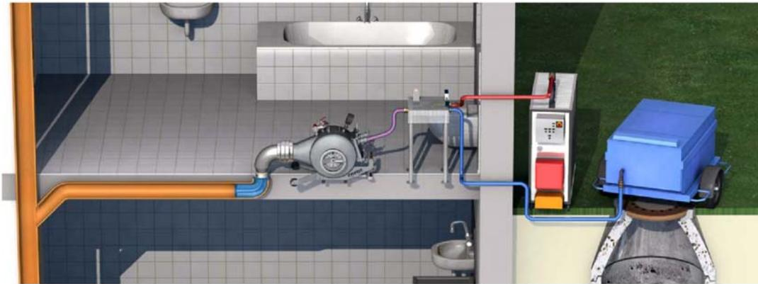
1. Schlauchliner am Startpunkt positionieren, Steuerband am Dampfauslassventil fixieren.
