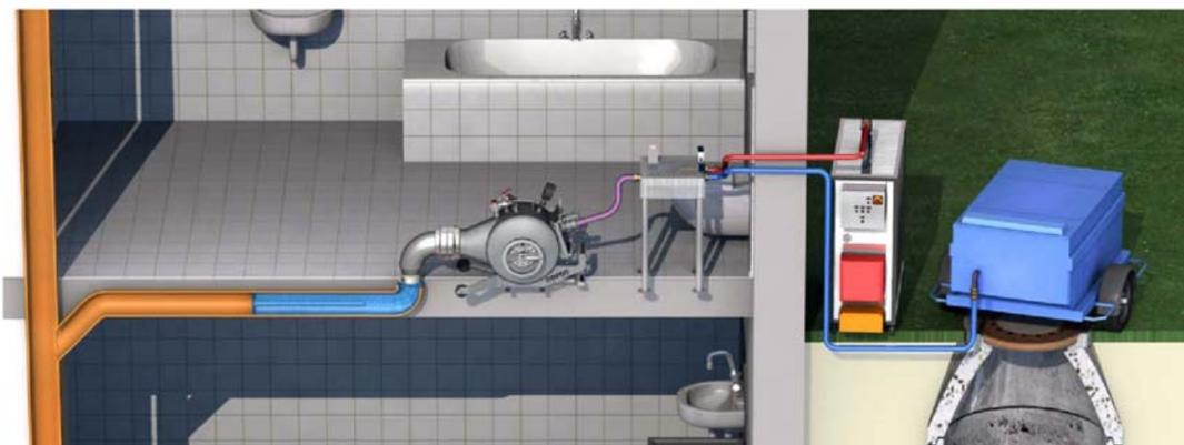
2. Inversion des Schlauchliners mit offenem Ende (Open End).
