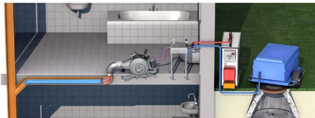
3. Schlauchliner vom Inversionsstutzen trennen, Kalibrierschlauch einführen und am Startpunkt positionieren.
