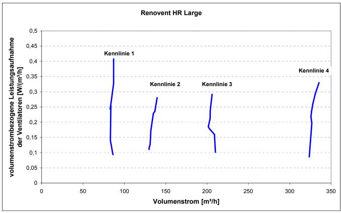
Zentrale Lüftungsgeräte mit Wärmerückgewinnung "Renovent HR Medium, Renovent HR Large"
