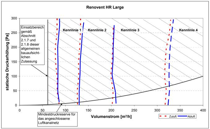
Zentrale Lüftungsgeräte mit Wärmerückgewinnung "Renovent HR Medium, Renovent HR Large"
