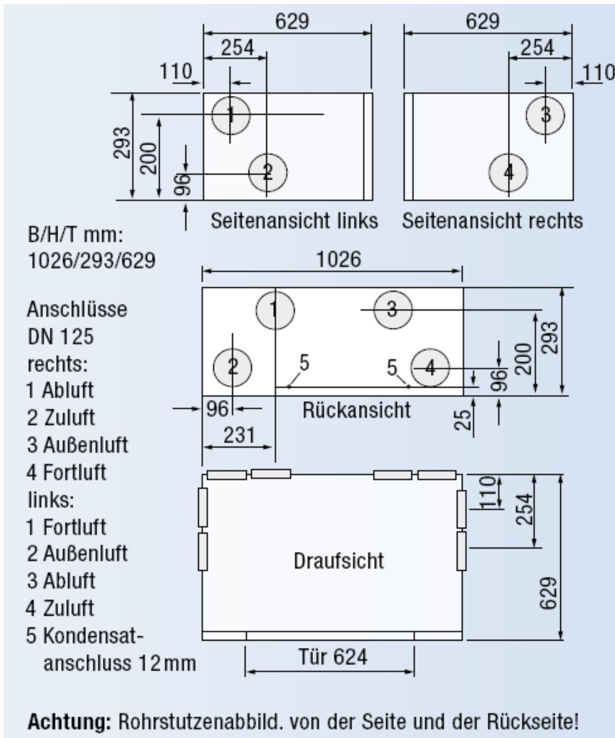
Zentrales Lüftungsgerät mit Wärmerückgewinnung - "Vallox ValloMulti 300 SB"
