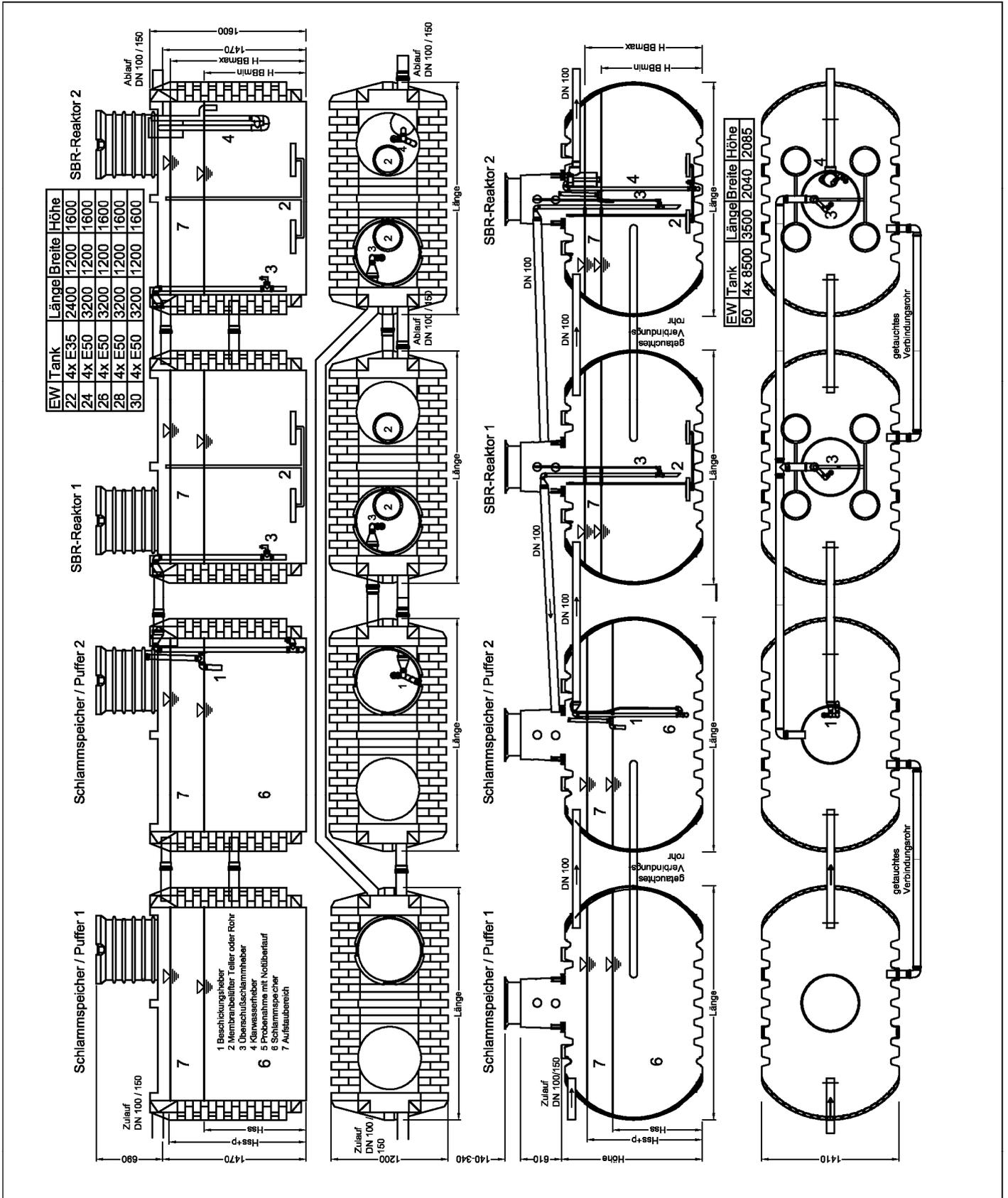
Anwendungsbestimmungen für Kleinkläranlagen nach DIN EN 12566-3 mit CE-Kennzeichnung: Typ Klaro Easy aus PE für 4 bis 50 EW, Ablaufklasse N
