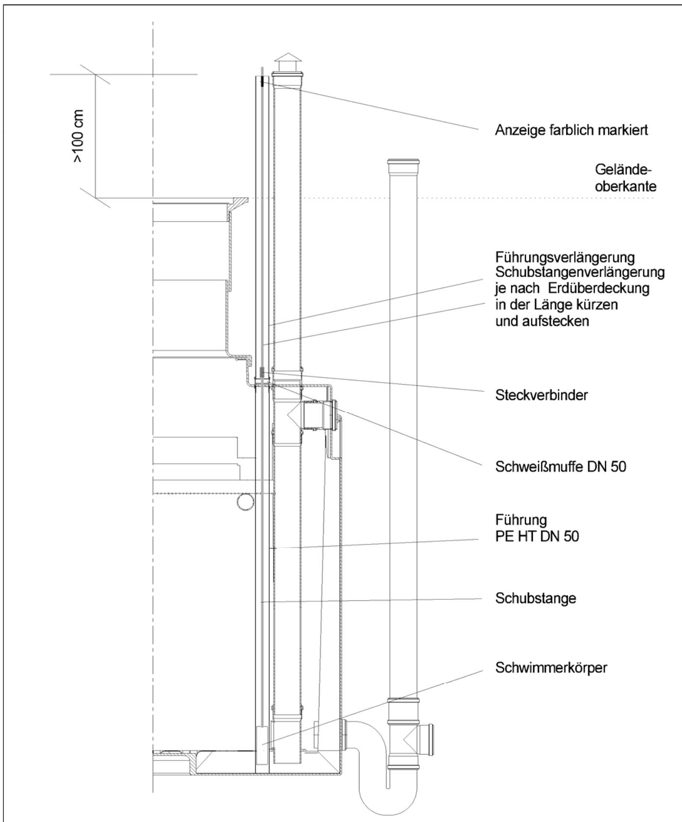
Anwendungsbestimmungen für Kleinkläranlagen nach DIN EN 12566-3 mit CE-Kennzeichnung: Biofilmanlage mit Filtrationswirkung Typ "Clearfox nature" aus PE
