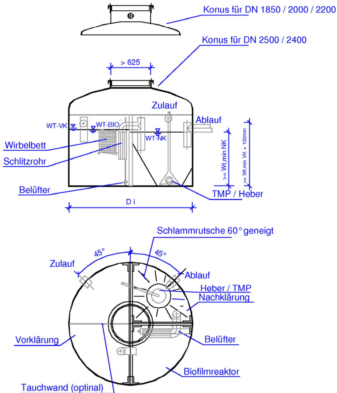
Anwendungsbestimmungen für Kleinkläranlagen nach DIN EN 12566-3 mit CE-Kennzeichnung: Wirbel-/Schwebebett-/Biofilmverfahren Typ WSB®-clean-GFK-N
