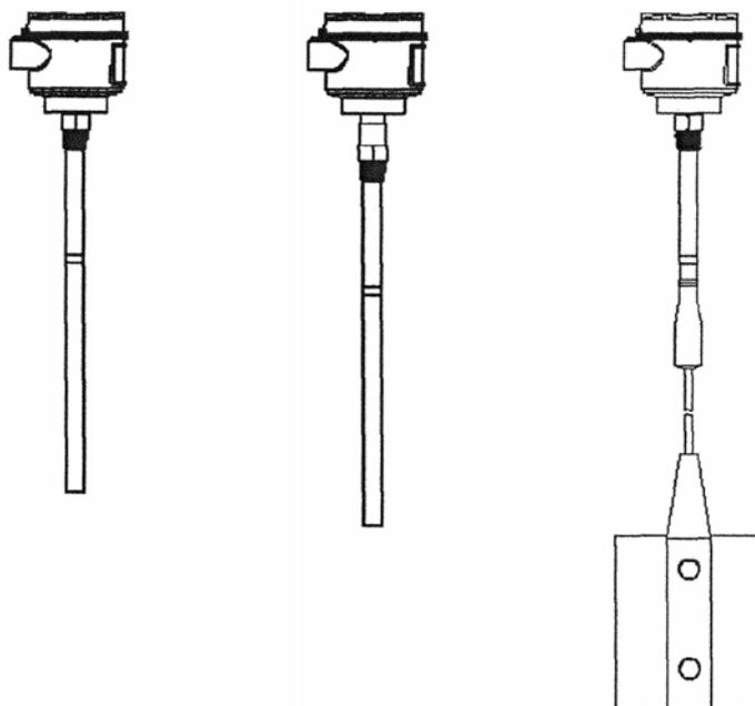
**Schema der Überfüllsicherung**
