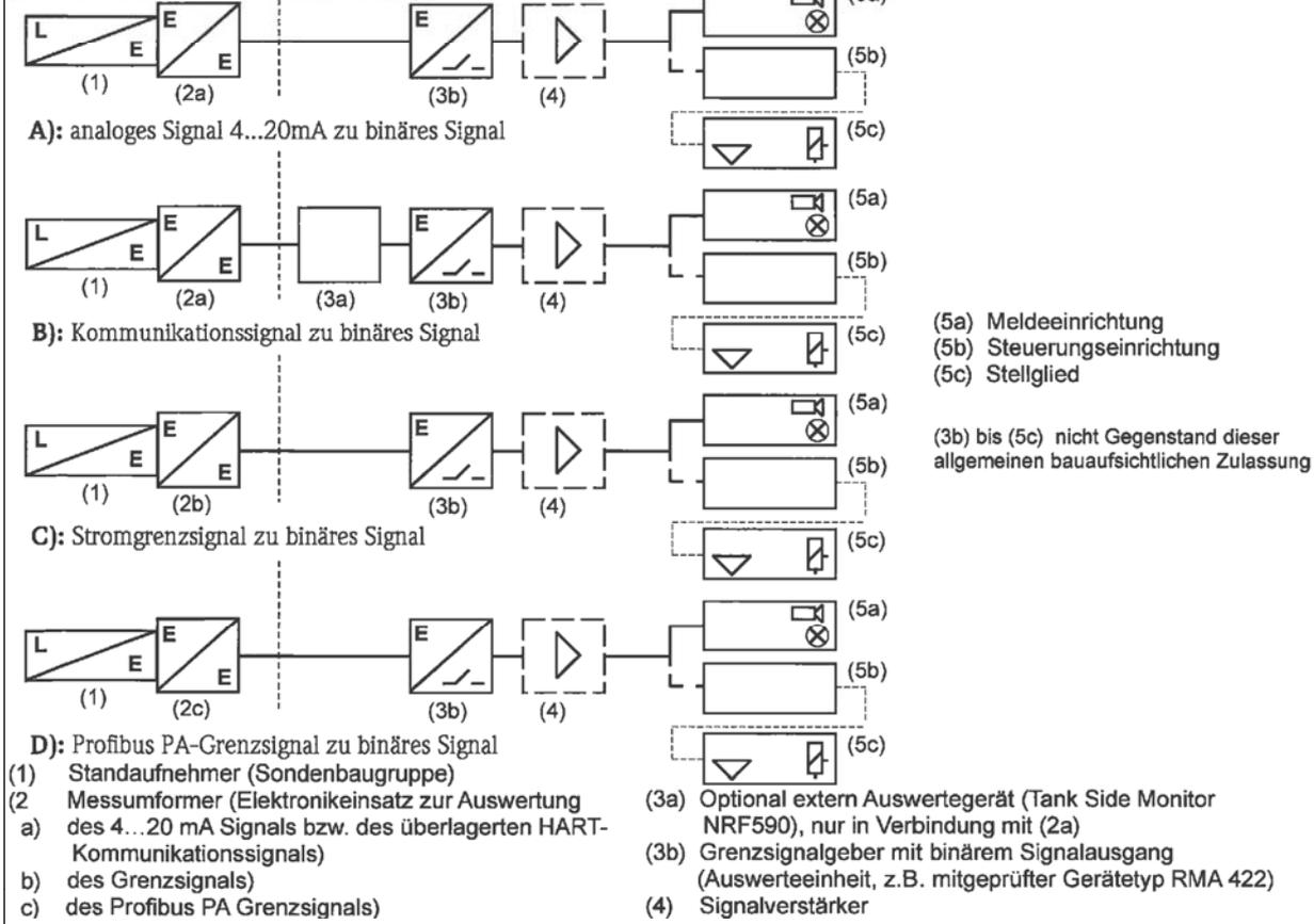
Standaufnehmer "Levelflex, Typ FMP 5..." mit integriertem Messumformer als Anlageteil von Überfüllsicherungen
