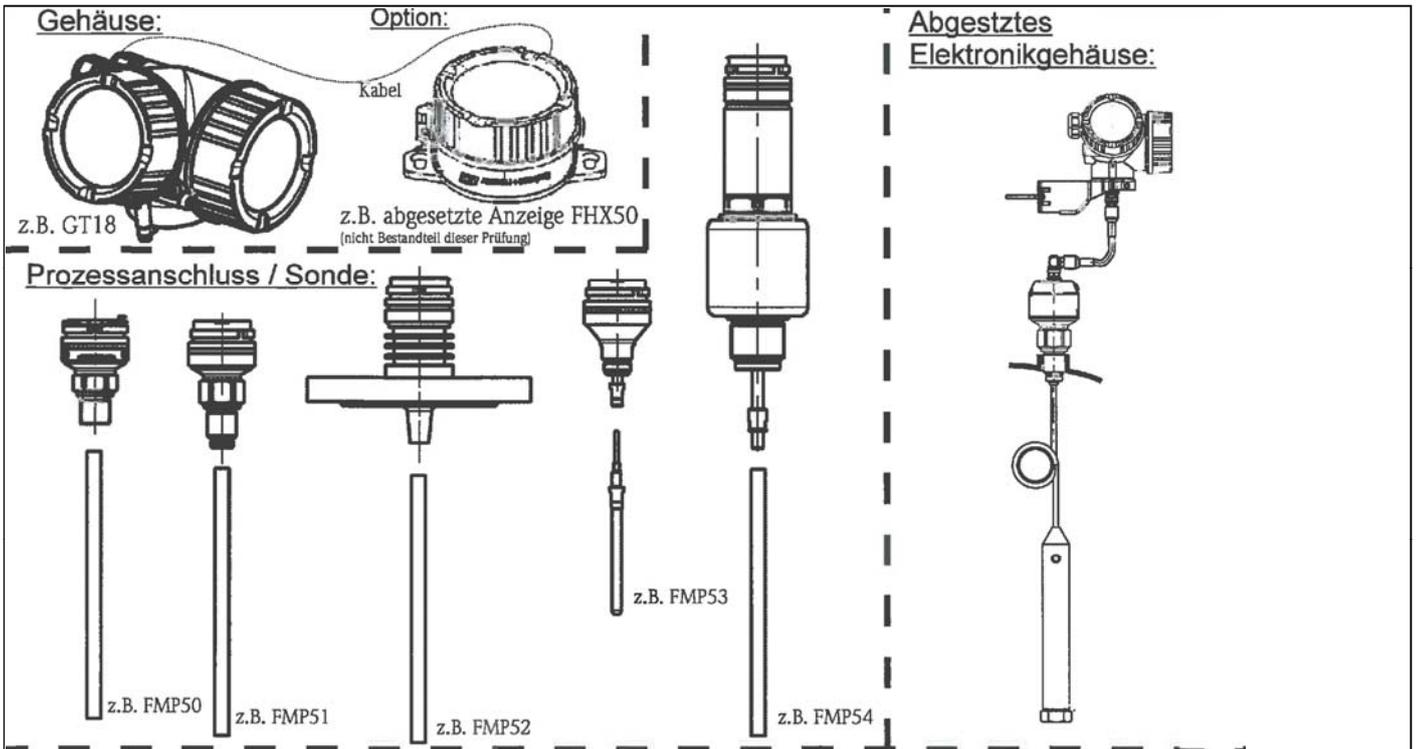
**Schema der Überfüllsicherung**
