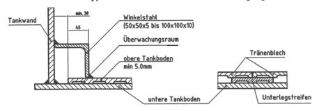
Leckschutzauskleidung aus Stahl Typ H 021 Q und Typ H 021 TR für Flachbodentanks nach DIN 4119
