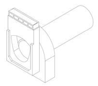
ACO DRAIN S 100 K, S 150 K, S 200 K, S 300 K Linienentwässerungssystem für die Verwendung in LAU-Anlagen
