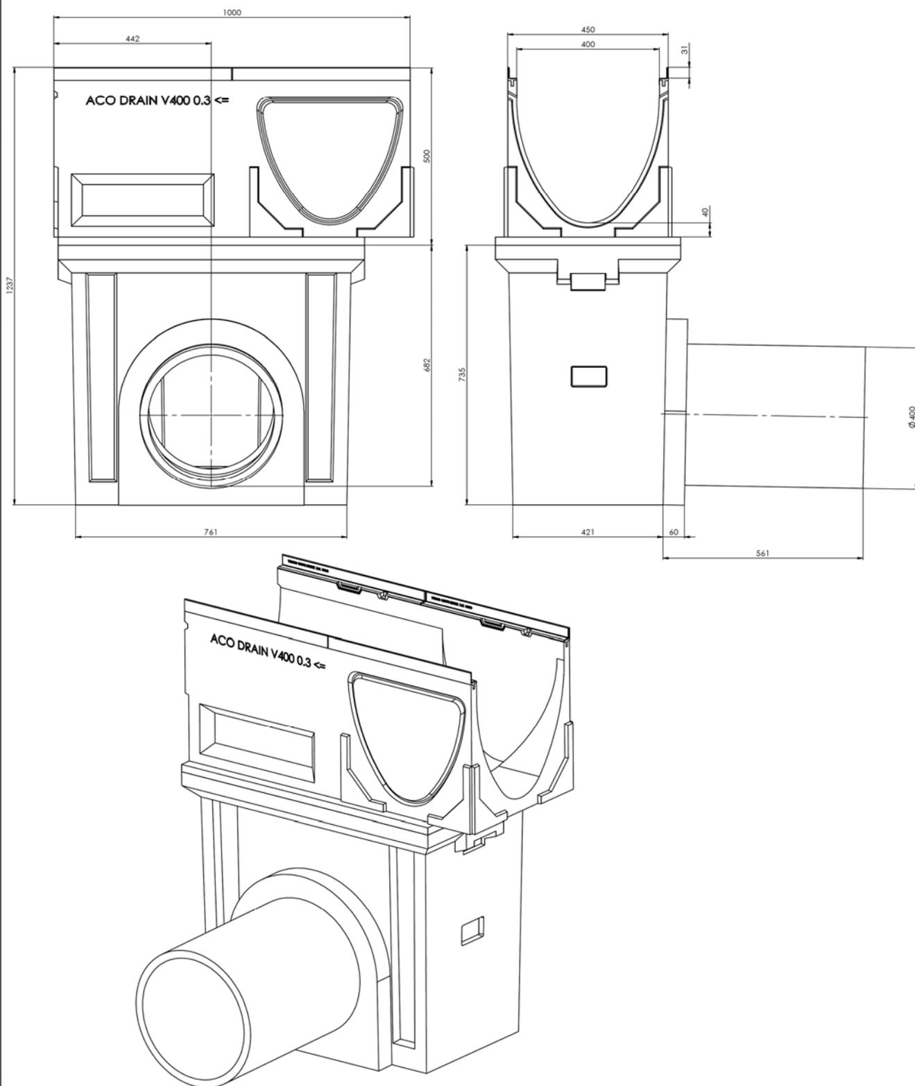
ACO DRAIN Multiline Rinnensystem für die Verwendung in LAU-Anlagen
