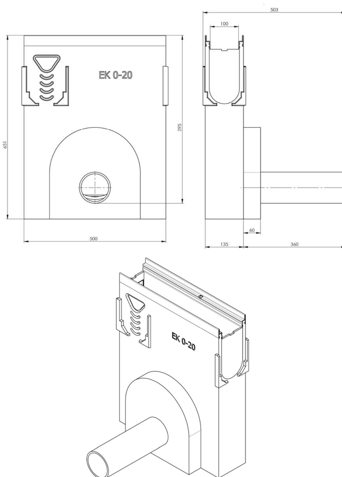
ACO DRAIN Multiline Rinnensystem für die Verwendung in LAU-Anlagen
