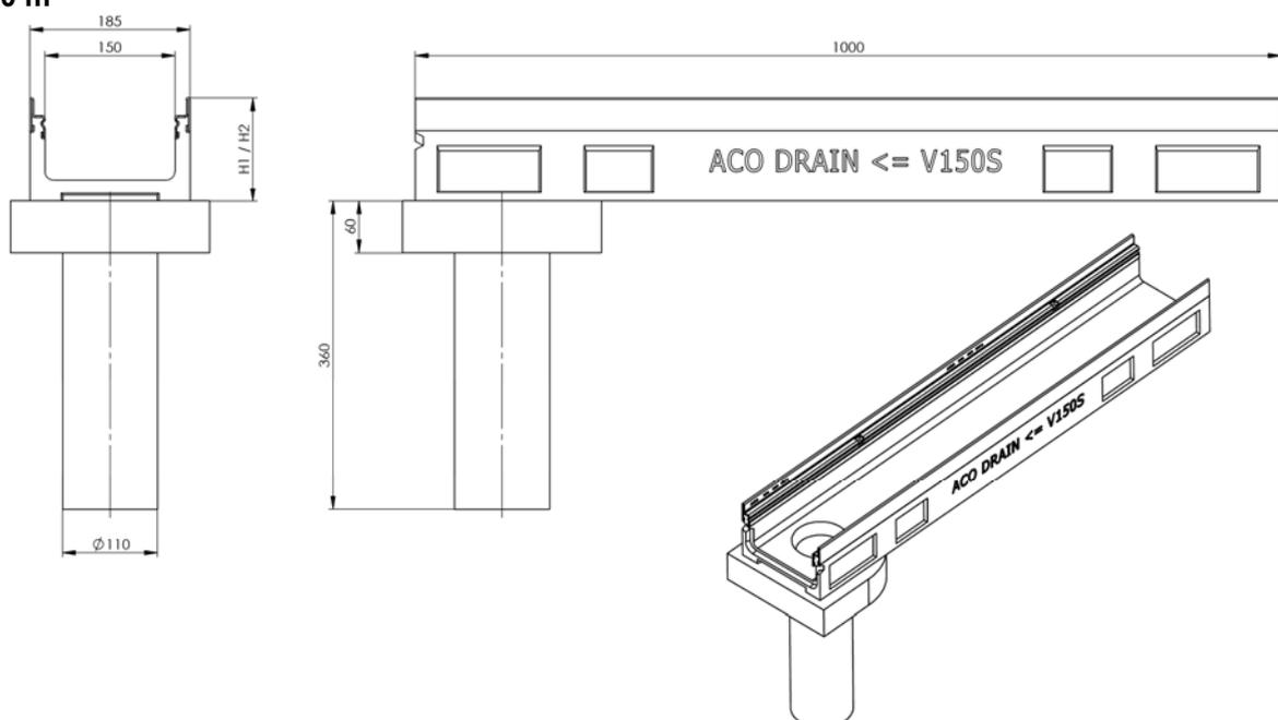
ACO DRAIN Multiline Rinnensystem für die Verwendung in LAU-Anlagen
