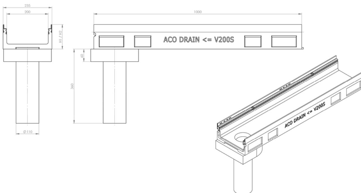
ACO DRAIN Multiline Rinnensystem für die Verwendung in LAU-Anlagen
