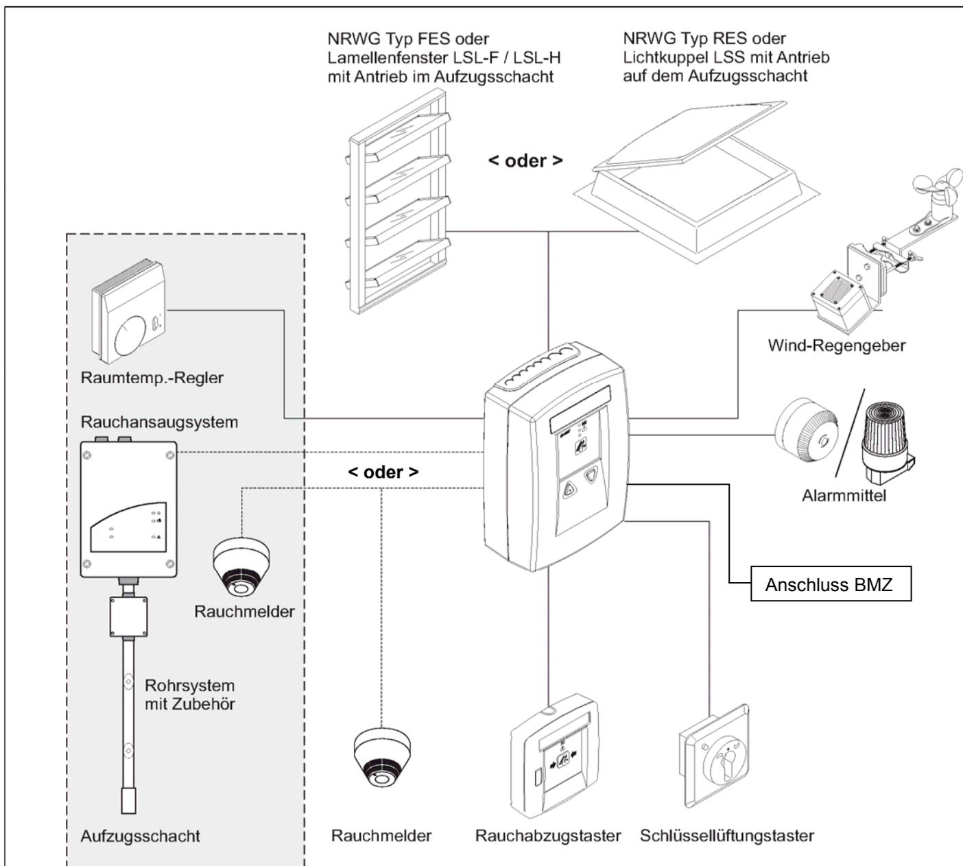
Die LSC ist speziell für die Anwendung als Steuerung für die Aufzugsschachtbelüftung und -rauchableitung entwickelt worden.
