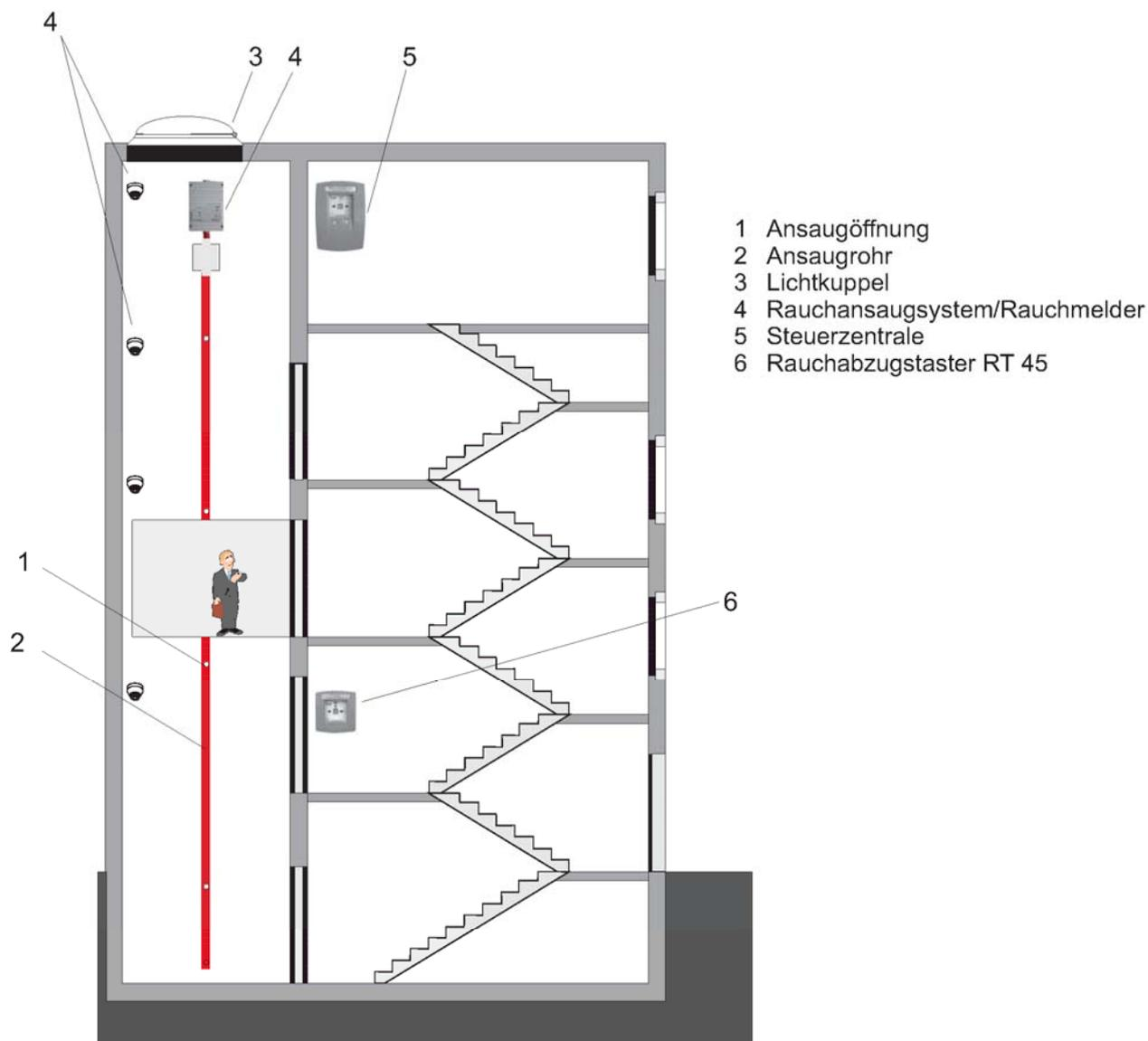
Im RWA-Fall wird der elektromotorische Öffnungsantrieb durch einen Nachtaktbetrieb angesteuert.
