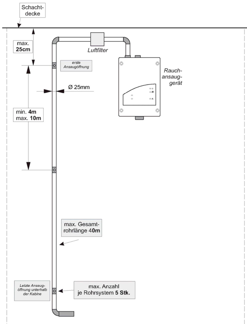
Bauprodukt "System zur Rauchableitung aus Fahrschächten von Aufzügen im Inneren von Gebäuden Typ LSC Basic-RM oder LSC Basic"
