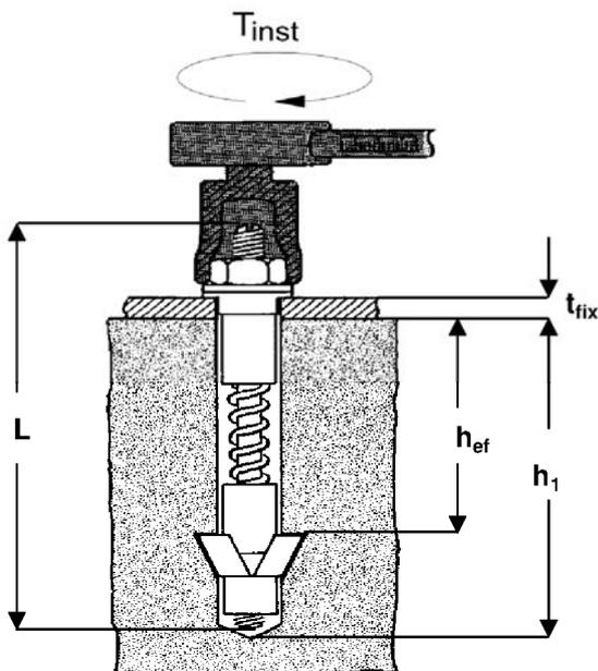
Montagedrehmoment  $T_{inst}$  mittels kalibriertem Drehmomentschlüssel aufbringen.
