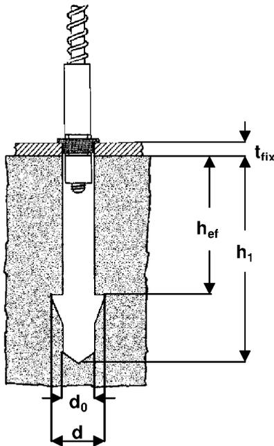
Der Sormat Liebig Ultraplus™ A4 Hinterschneidanker wird durch das Anbauteil in das Bohrloch gesetzt. Der Kunststoffstift, der die Spreizsegmente zusammenhält, wird abgestreift und gibt die Spreizsegmente frei. Beim Erreichen der Hinterschneidung öffnen sich diese durch den Federdruck automatisch und rasten spür- und hörbar ein.
