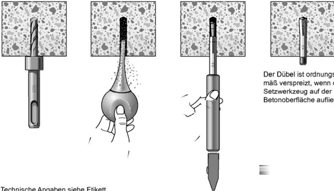
Der Dübel ist ordnungsgemäß verspreizt, wenn das Setzwerkzeug auf der Betonoberfläche aufliegt.
