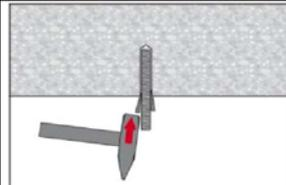
Bei Überkopfanwendung das Element in seiner endgültigen Position, z.B. mittels Keilen HIT-OHW, gegen Herausrutschen sichern.
