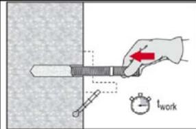
Vor der Montage sicherstellen, dass das Element trocken und frei von Öl und anderen Verunreinigungen ist.
