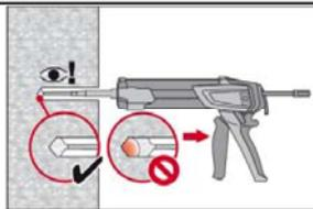
Injizieren des Mörtels vom Bohrlochgrund und während jedem Hub den Mischer langsam etwas herausziehen.
