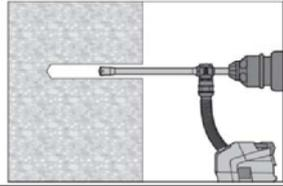
Die Bohrlocherstellung bis zur erforderlichen Setztiefe erfolgt dreh Schlagend mit einem Hilti Hohlbohrer TE-CD oder TE-YD mit Hilti Staubsaugeranschluss. Dieses Bohrsystem beseitigt bei Anwendung gemäß der Gebrauchsanweisung des Hohlbohrers das Bohrmehl und reinigt das Bohrloch während des Bohrvorgangs. Nach Beendigung des Bohrens kann mit Mörtelverfüllung gemäß Gebrauchsanweisung begonnen werden.
