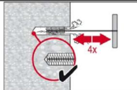
4-mal mit Stahlbürste in passender Größe (Bürste  $\varnothing \geq$  Bohrloch  $\varnothing$ , siehe Tabelle 8) bürsten. Stahlbürste Hilti HIT-RB mit einer Drehbewegung in das Bohrloch bis zum Bohrlochgrund einführen und wieder herausziehen (falls notwendig mit Verlängerung). Die Bürste muss beim Einführen einen Widerstand erzeugen – falls nicht, ist die Bürste zu klein und muss durch eine größere Bürste ersetzt werden.
