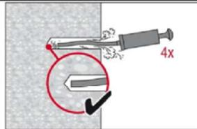
Für Bohrl Lochdurchmesser  $d_0 \leq 20\text{ mm}$  und Bohrloch tiefen  $h_0 \leq 20d$  oder  $h_0 \leq 250\text{ mm}$  kann die Hilti Handausblaspumpe verwendet werden.
