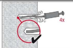
Bohrloch erneut mit der Hilti Handausblaspumpe vom Bohrlochgrund mindestens 4-mal ausblasen, bis die rückströmende Luft staubfrei ist.
