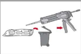
Das Öffnen der Foliengebilde erfolgt automatisch bei Auspressbeginn. Der am Anfang aus dem Mischer austretende Mörtelvorlauf darf nicht für Befestigungen verwendet werden.
