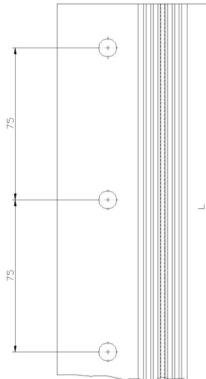
**Vertikales Verbindungsprofil "HECK Verbindungsleiste PVC"** (Maße in mm)
