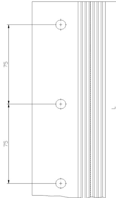
**Vertikales Verbindungsprofil (Maße in mm)**
